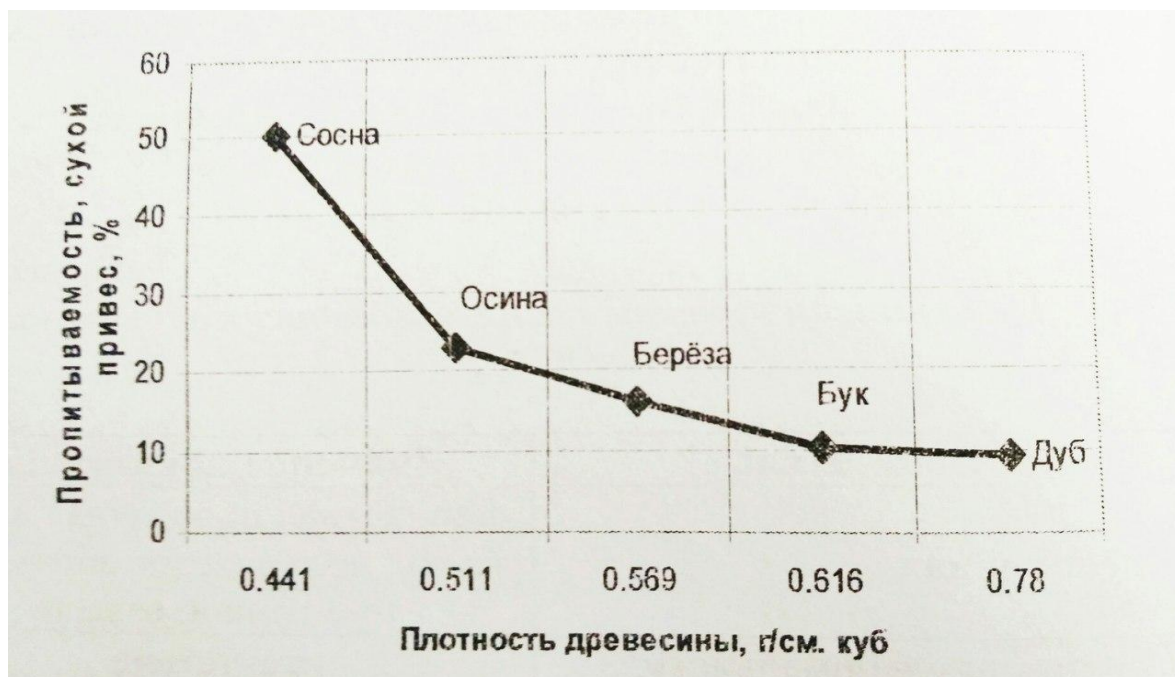
Рисунок 3.1 – Влияние плотности древесины на ее пропитываемость огнезащитным составом «ОСА-1»
