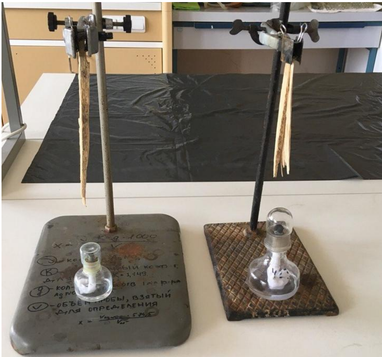
Рисунок 5.3 – Лабораторная установка для сжигания образцов древесины
