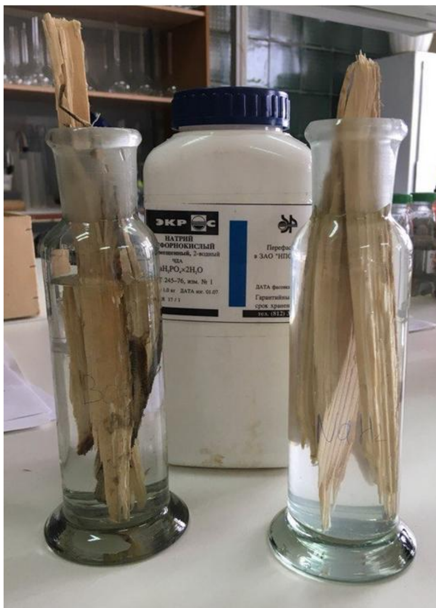
Рисунок 5.1 – Вымачивание образцов сосны в воде (слева) и водном растворе дигидрофосфата натрия (справа)
