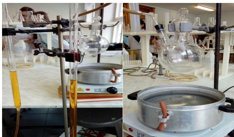
Рисунок 5- Установка по вытеснению жидкости газом
