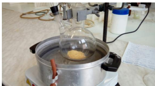
Рисунок 6- Нагрев на водяной бане пенообразователя
