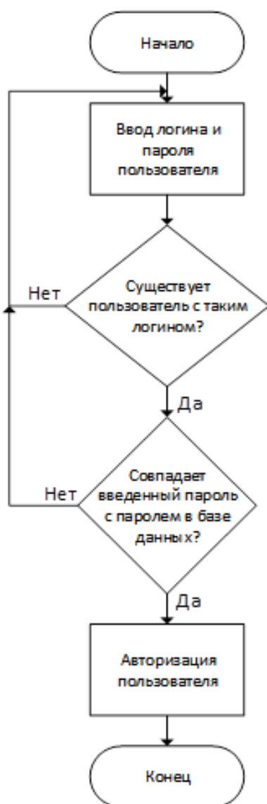
Рисунок 3.2 – Блок-схема модуля авторизации пользователя
