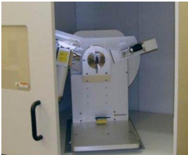
Рисунок 15 - Рентгеновский дифрактометр *Shimadzu XRD-7000S*
