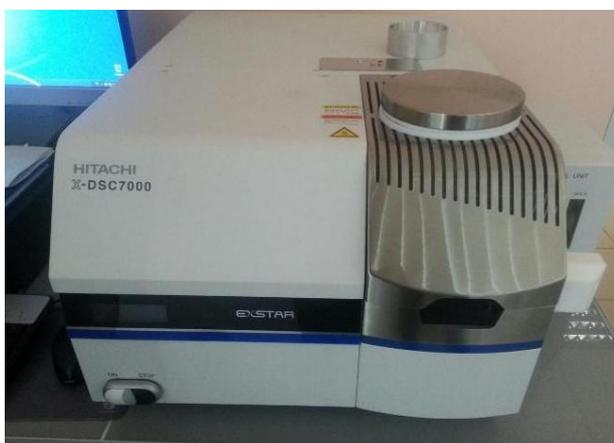
Рисунок 14 - Дифференциальный сканирующий калориметр *X-DSC7000*
