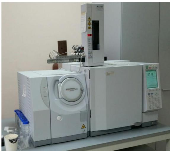
Рисунок 21 – Хромато-масс-спектрометр *Shimadzu GCMS-QP2010 Ultra*
