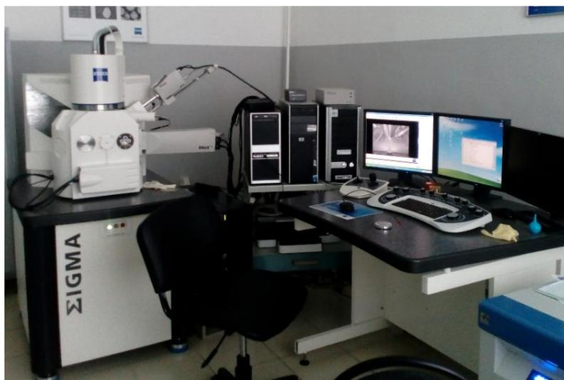
Рисунок 12 - Сканирующий электронный микроскоп *Zeiss SIGMA*
