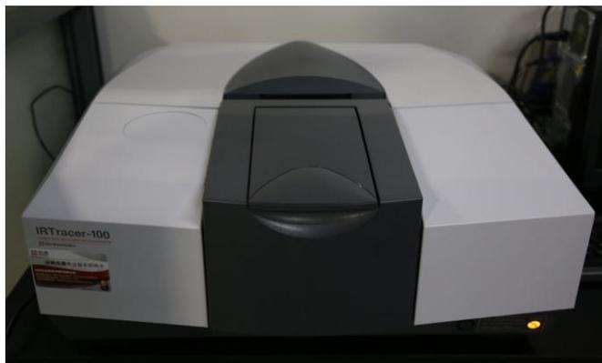
Рисунок 20 – ИК-спектрометр *IRTracer-100 Shimadzu*
