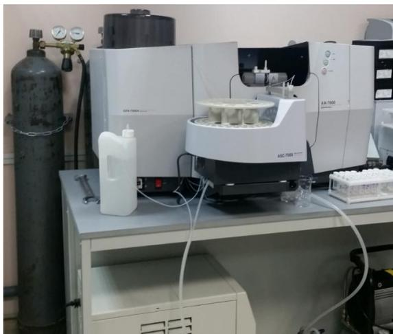
Рисунок 22 – Атомно-абсорбционный спектрометр *Shimadzu AA-7000*
