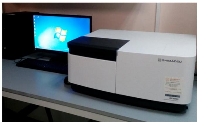
Рисунок 19 - Спектрофлуориметр *Shimadzu RF-6000*
