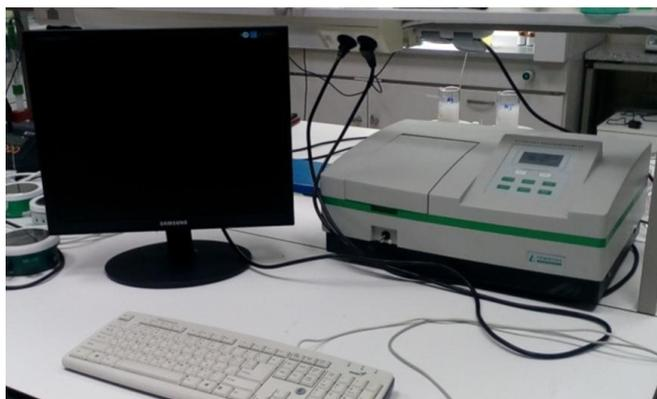
Рисунок 17 – Спектрофотометр *Промэнерголаб ПЭ-5400УФ*
