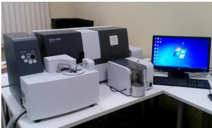
Рисунок 13 - Лазерный дифракционный анализатор *Sald 2300*
