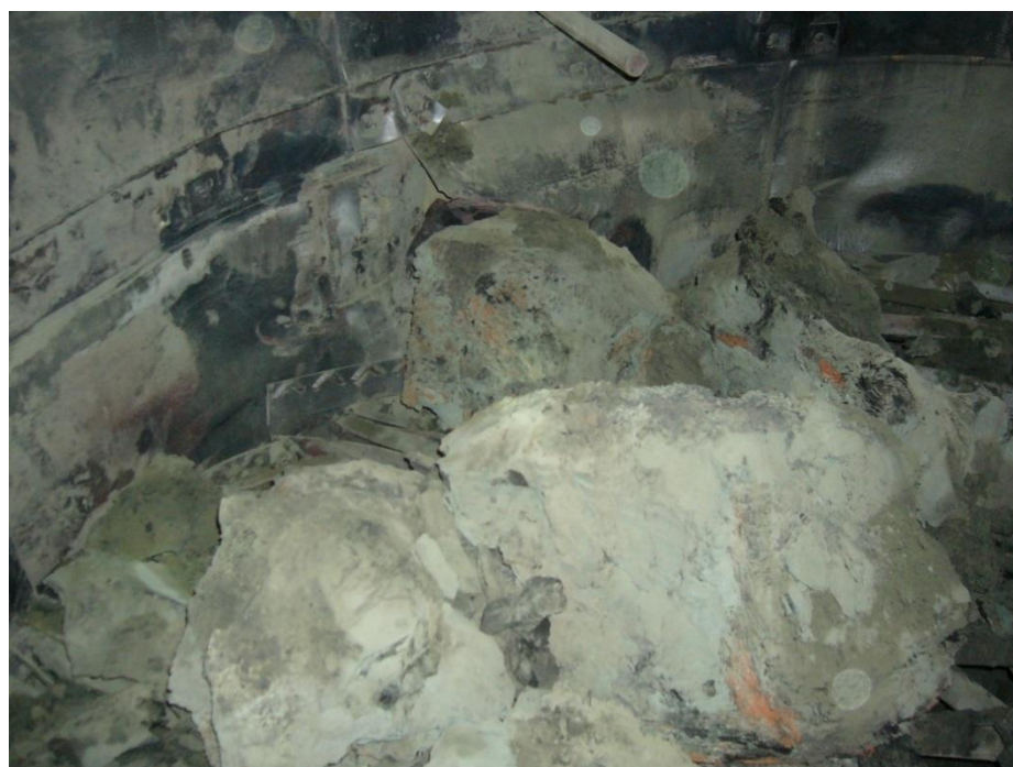
Рисунок 4.3 Отслоение кокса со стенок реактора на внутреннюю решетку
