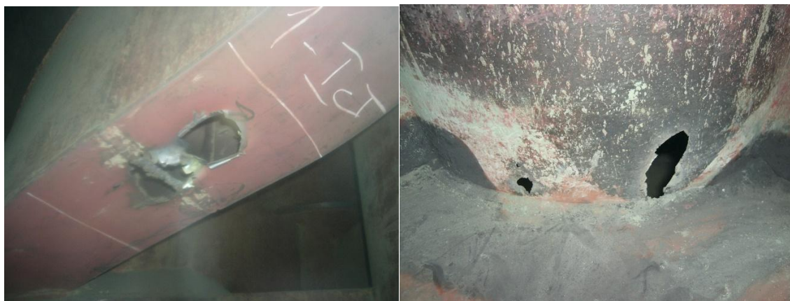
Рисунок 4.2 Отверстия в корпусах циклонов (слева) и у основания (справа)
