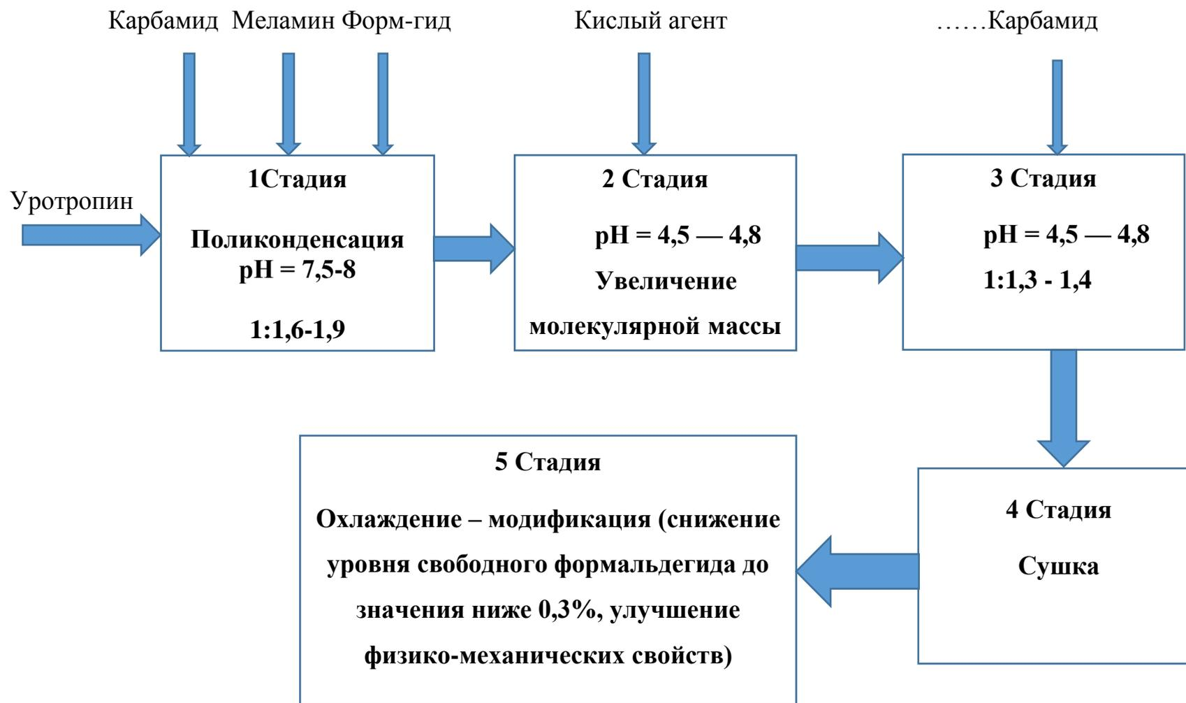
Рисунок 2.1 – Блок-схема технологии получения карбамидоформальдегидной смолы [29]
