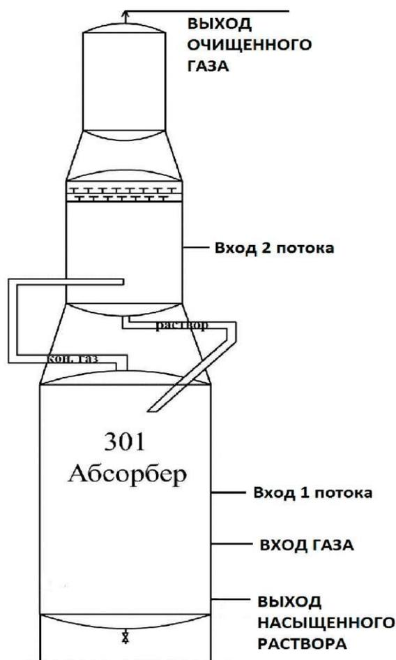
Рисунок 1.7 - Материальные потоки абсорбера очистки газа
