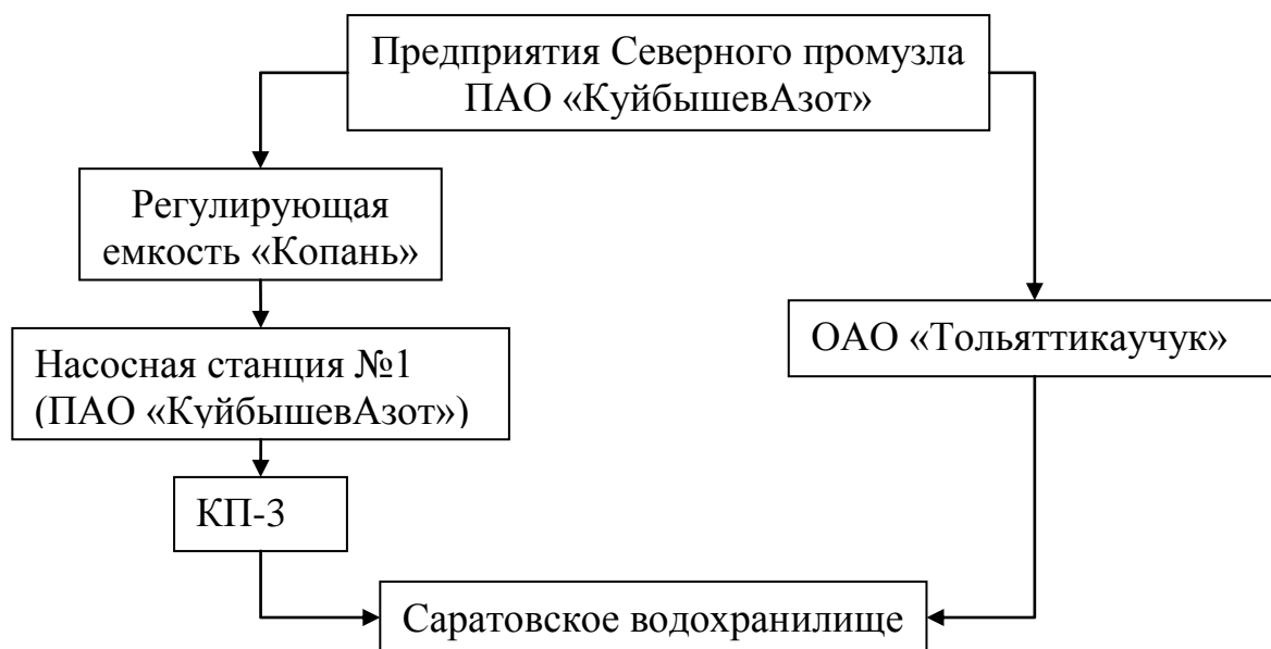
Рисунок 4 – Схема потоков сточных вод производств Северного промузла и ПАО «КуйбышевАзот»
