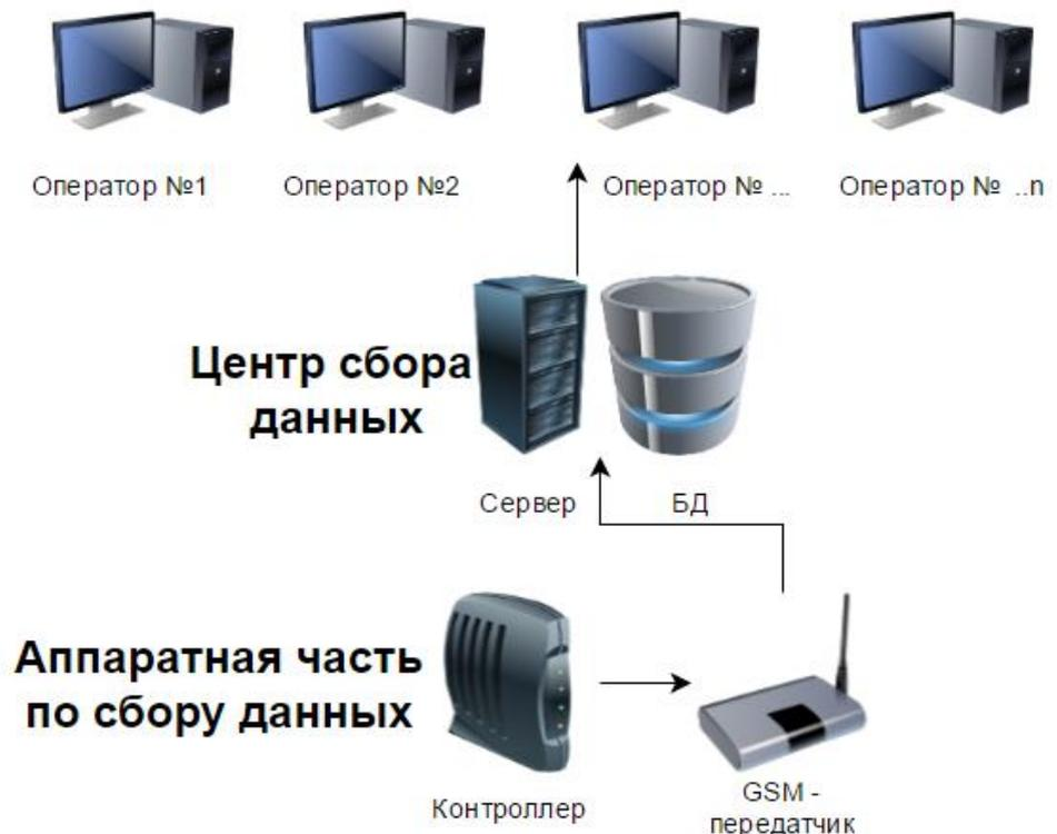
Рисунок 1.2 – Схема передачи данных «AS-IS»
