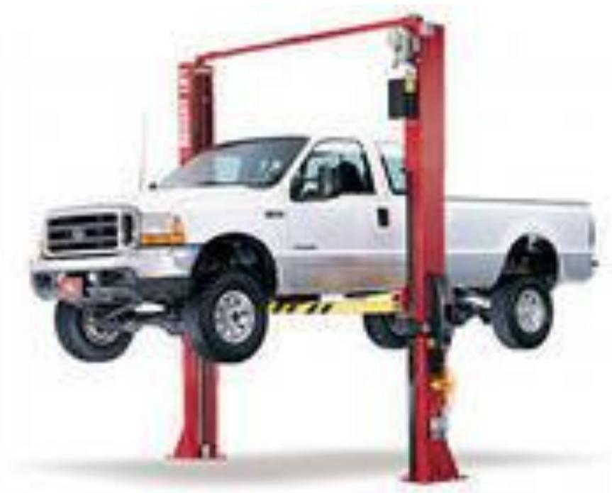
Рисунок 2.2 – Двухстоечный подъемник ПР-3
