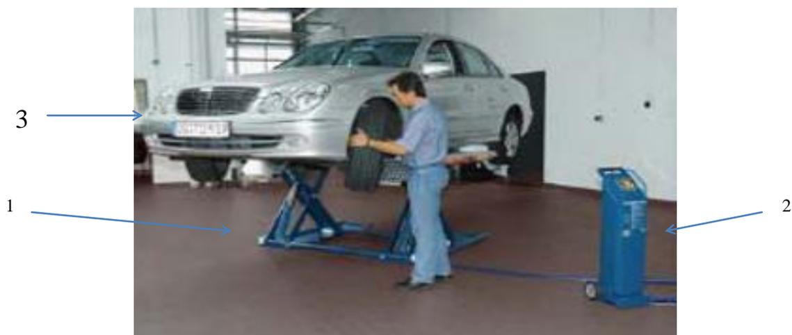
1 – подъемник, 2 – маслостанция, 3 – автомобиль на подъемнике
