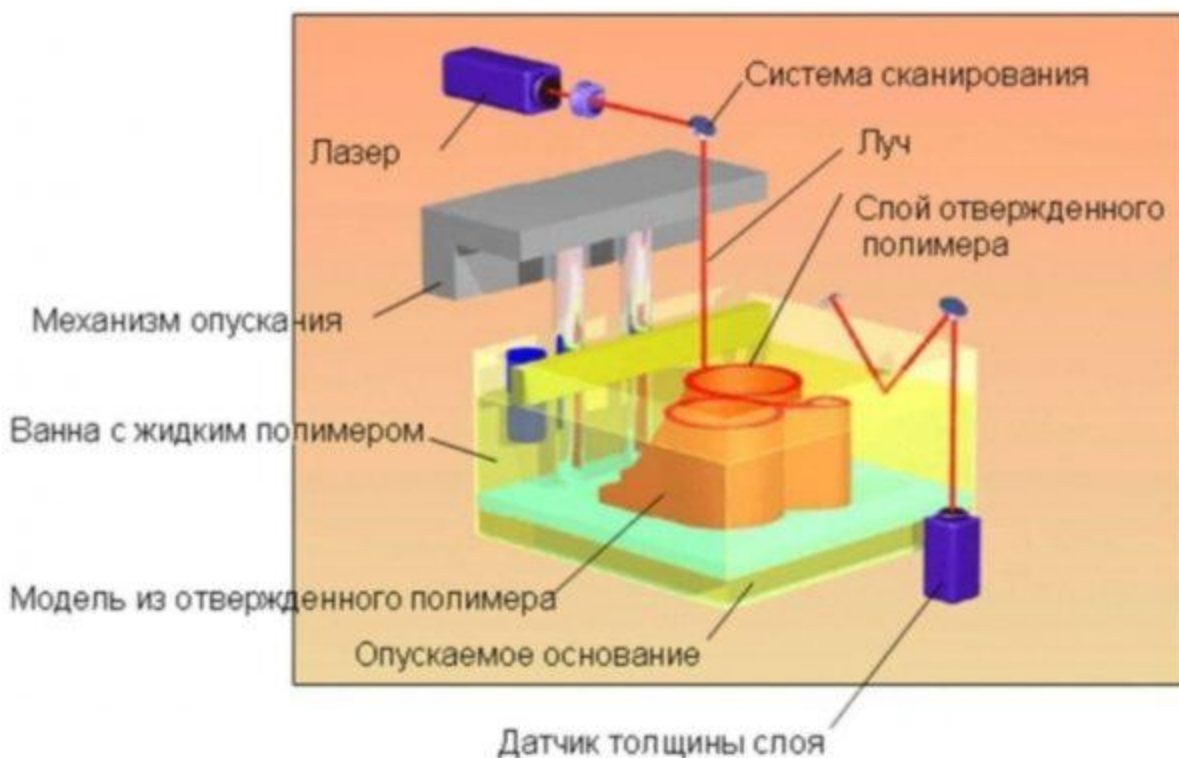
Рисунок 3.2 – Схема работы 3D-принтера на технологии SLA
