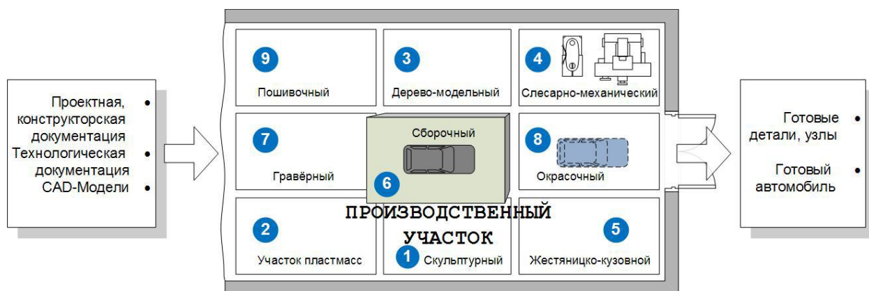
Рисунок 2.3 – Зонирование сборочного цеха
