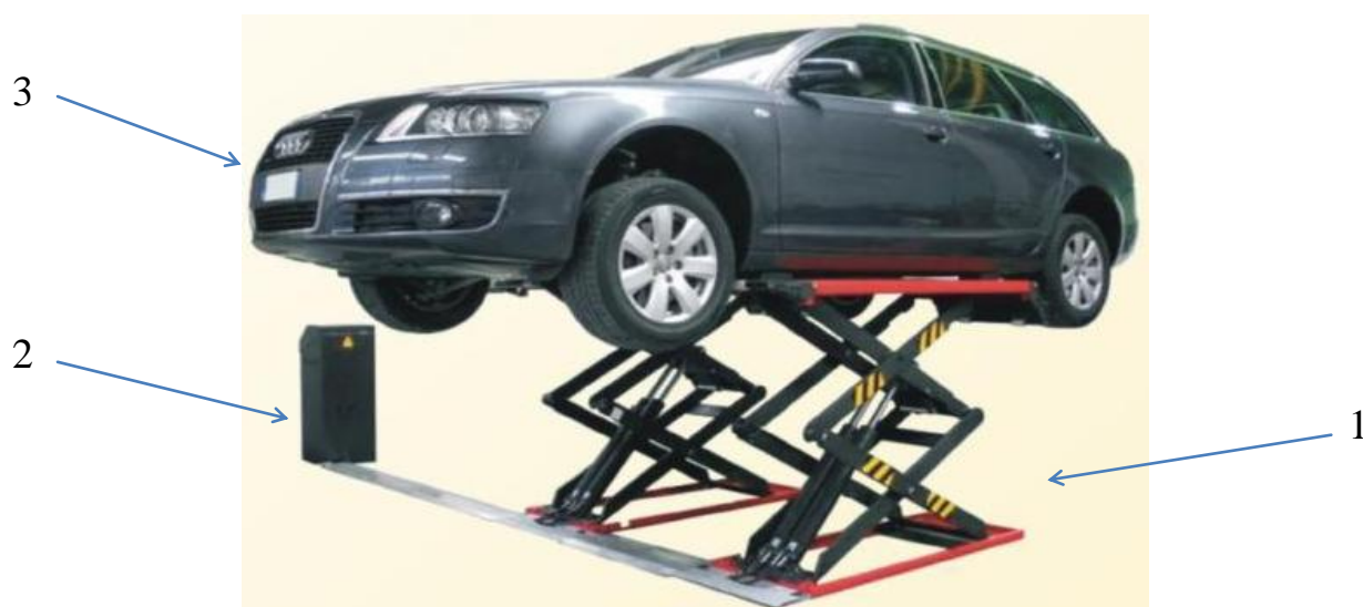
1 – подъемник, 2 – маслостанция, 3 – автомобиль на подъемнике
