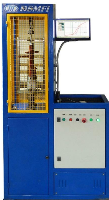
Рисунок 1.3 – Стенд для испытания амортизаторов ИТМ010201
