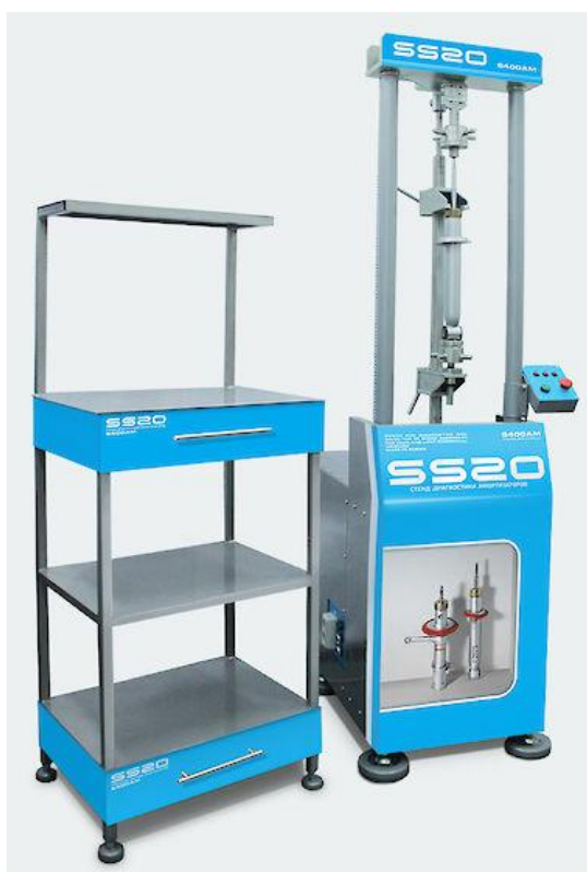
Рисунок 1.2 – Стенд диагностики амортизаторов «CENTURION» S400AM
