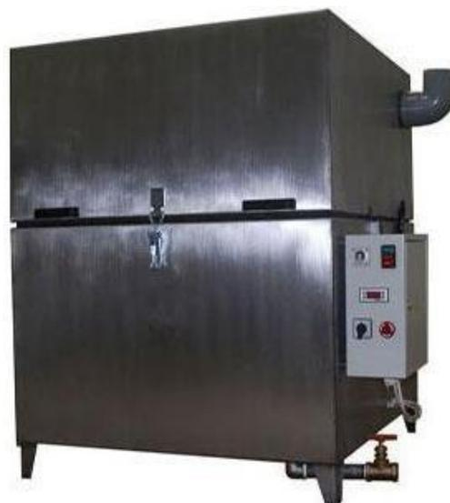
Рисунок 2.2 – Моечная машина ТС-900
