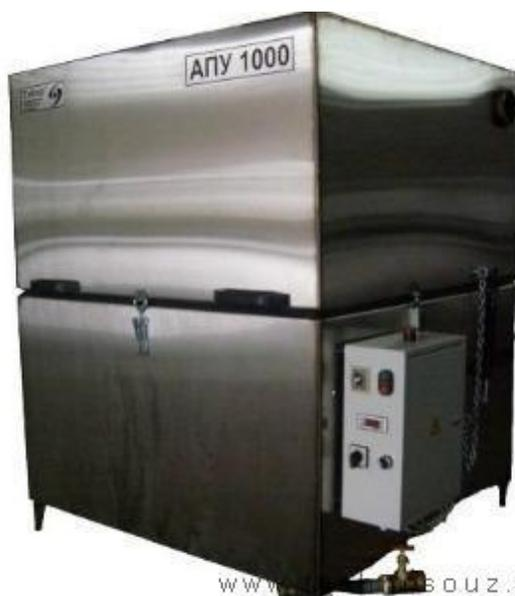
Рисунок 2.1– Моечная машина АПУ 1000
