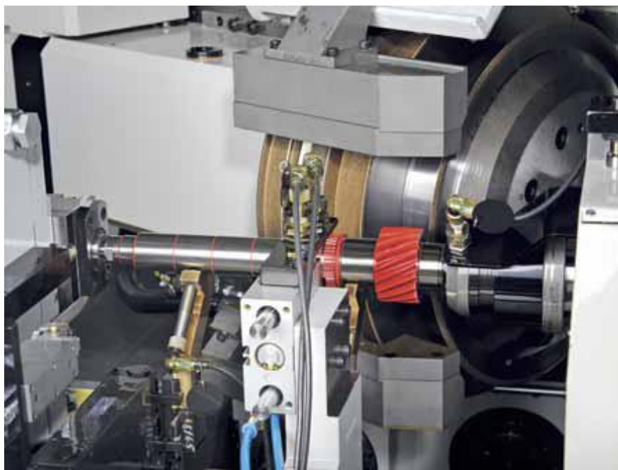
Рисунок 2.3 – Технология маятникового шлифования валов на станке JUCENTER 6L.
