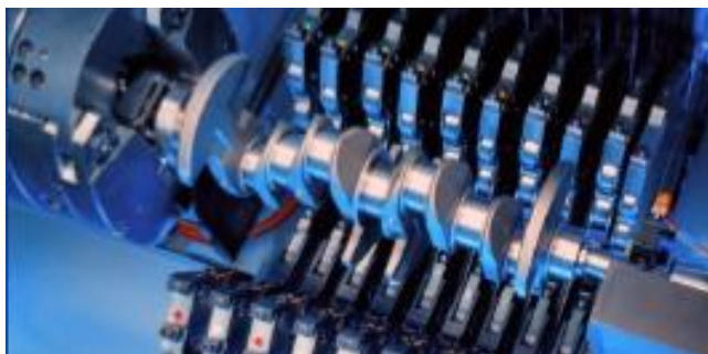
Рисунок 2.2 - Технология упрочнения радиусных галтелей коленчатого вала
