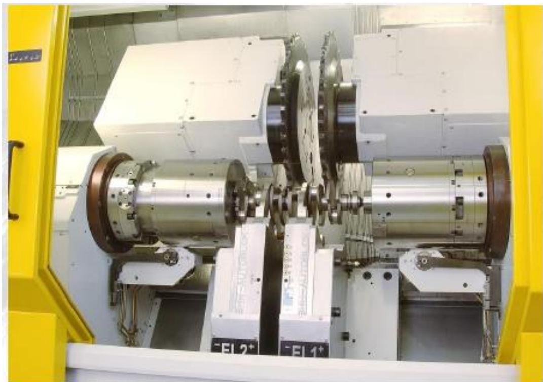
Рисунок 2.1 – Технология сдвоенного вихревого фрезерования шеек коленчатого вала
