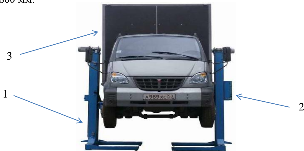
1 – подъемник, 2 – маслостанция, 3 – автомобиль на подъемнике
