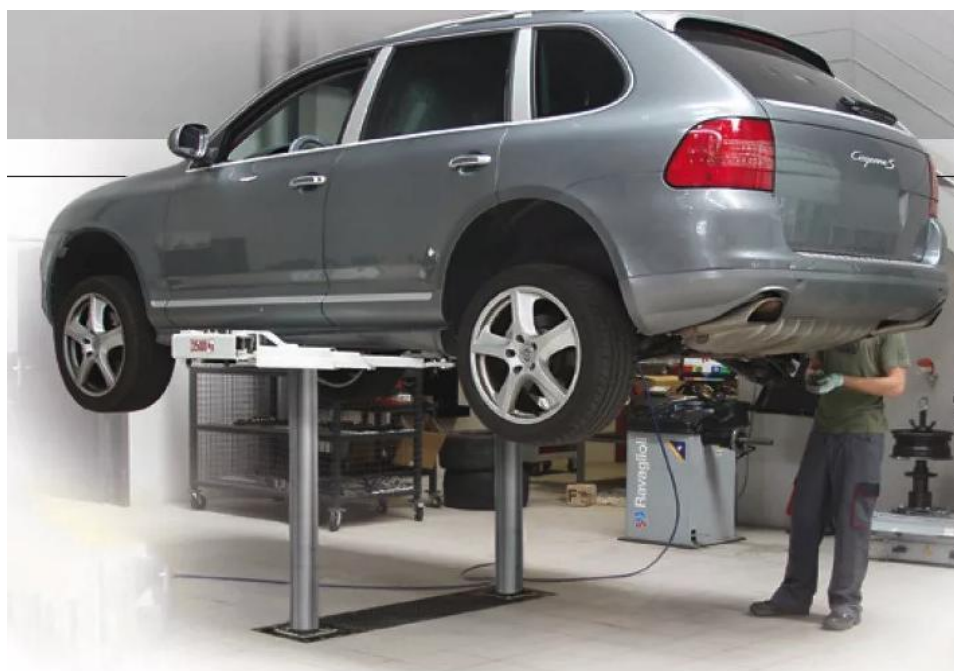
Рисунок 1.3 – Подъемник, обеспечивающий беспрепятственное снятие колес с автомобиля (шиномонтажный подъемник)
