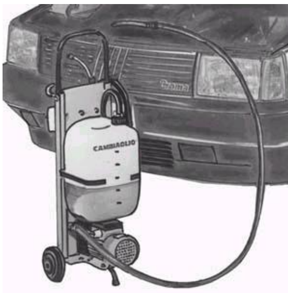
Рисунок 3.2 – Установка для раздачи масла GOVONI 305
