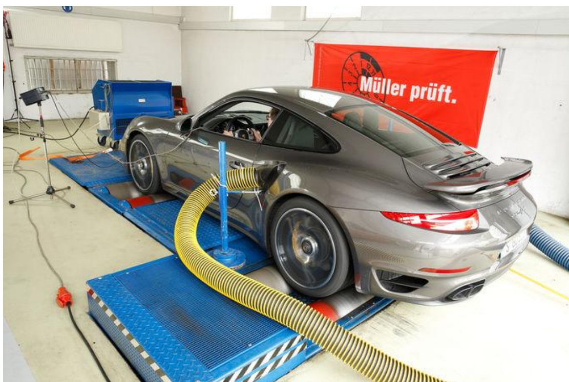
Рисунок 3.2 – Испытание на инерционном роликовом тормозном стенде
