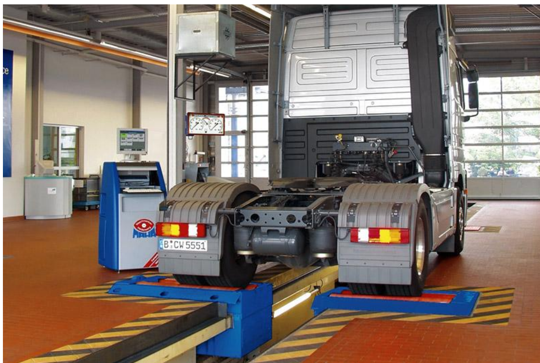
Рисунок 3.1 – Испытание на силовом роликовом тормозном стенде
