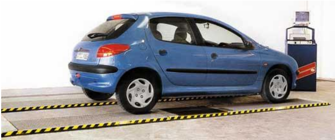
Рисунок 3.3 – Испытание на площадочном тормозном стенде
