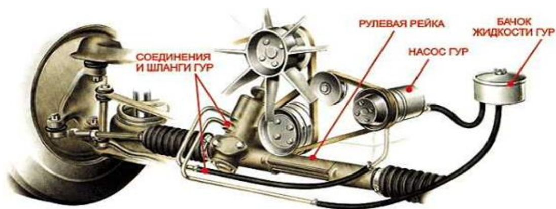
Рисунок 3.1 - Схема устройства ГУР легкового автомобиля
