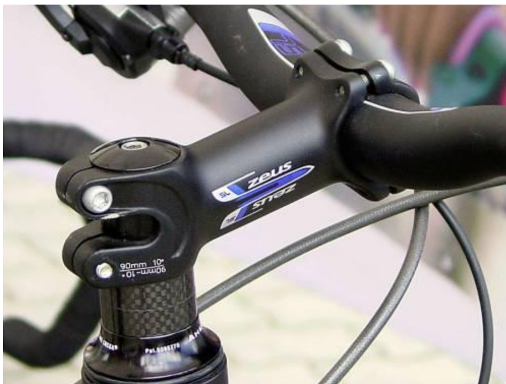
Рисунок 12 - Вид безрезьбовой рулевой колонки
