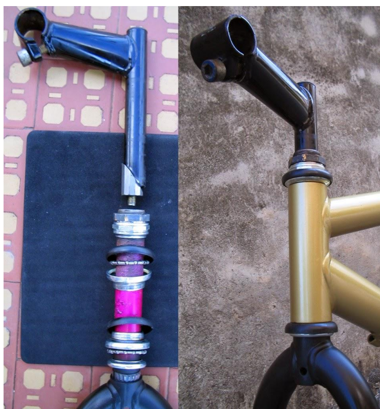
Рисунок 11 - Конструкция резьбовой рулевой колонки
