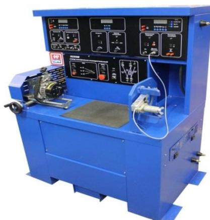
Рисунок 2.4 - Стенд для проверки генераторов и стартеров Э250М-02
