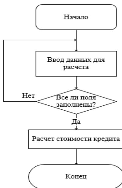
Рисунок 3.12 – Блок-схема модуля расчета стоимости кредита
