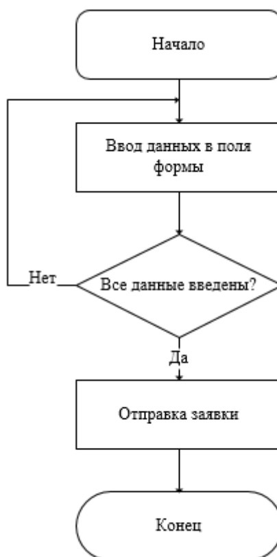
Рисунок 3.3 – Блок-схема модуля формирования заявки
