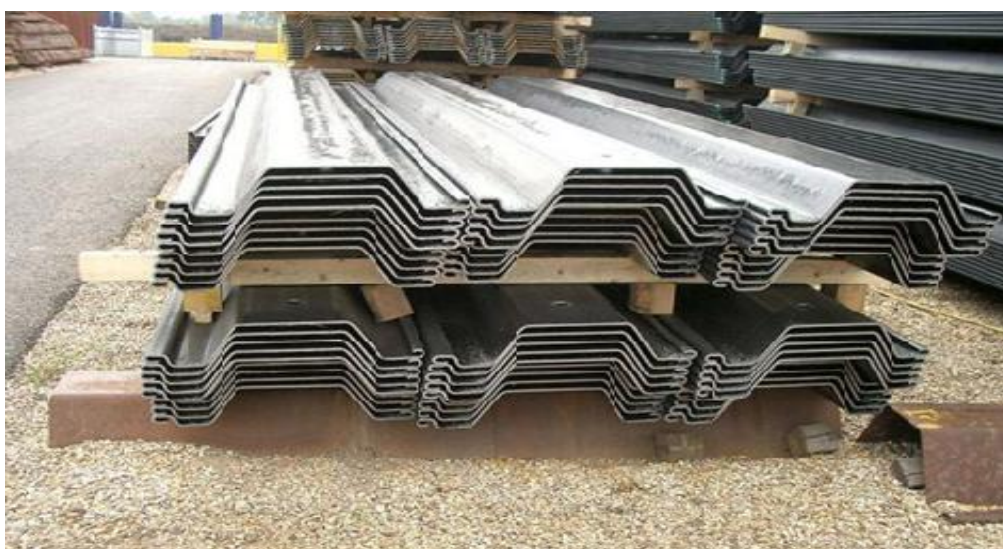
Рисунок 10 – Конструкция шпунтового свая
