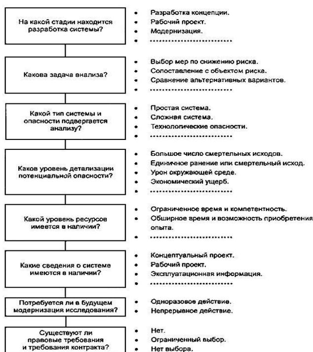
Рисунок 2 - Типовые рассуждения при выборе типа анализа и глубины исследования
