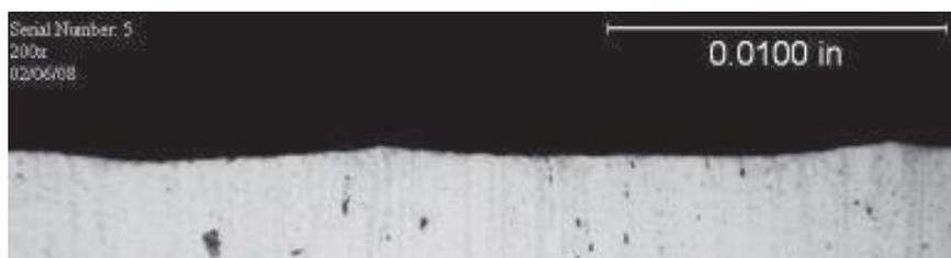
Рисунок 34 - Шероховатость ультразвуковой дробеструйной обработки
