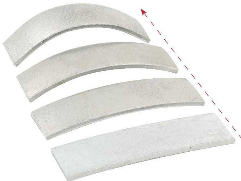
Рисунок 13 - Образование дуги после дробеструйной обработки
