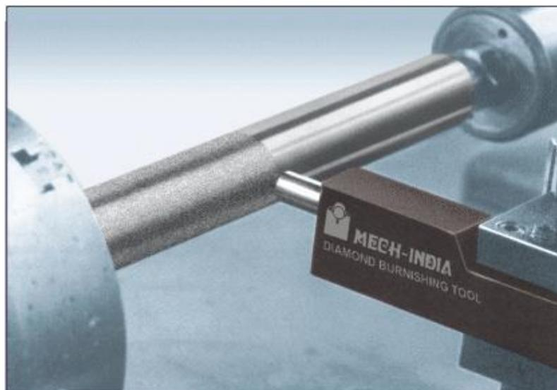
Рисунок 3 - Обработка алмазным выглаживателем наружной цилиндрической поверхности заготовки на токарном станке
