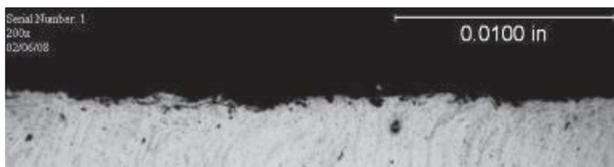
Рисунок 33 - Шероховатость обычной дробеструйной обработки
