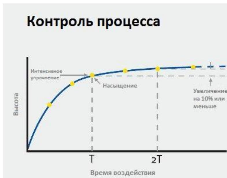
Рисунок 15 - Процесс контроля обработки
