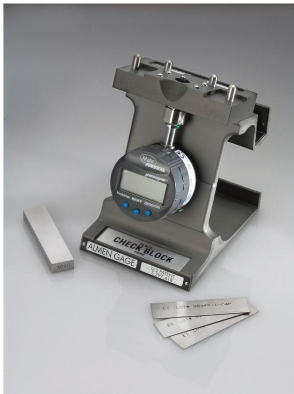
Рисунок 14 - Устройство «Almen Gage»
