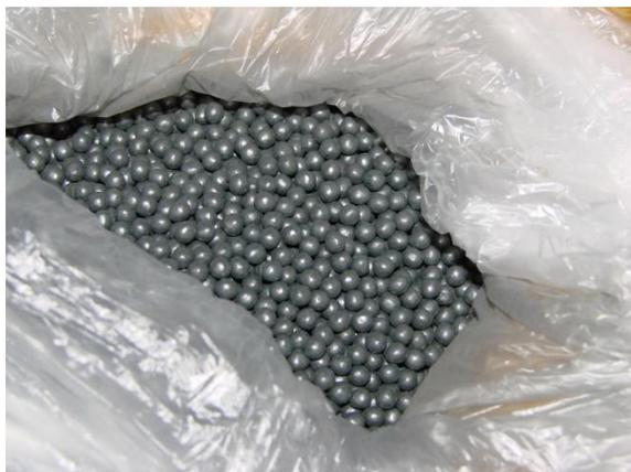
Рисунок 29 - Пластиковая дробь
