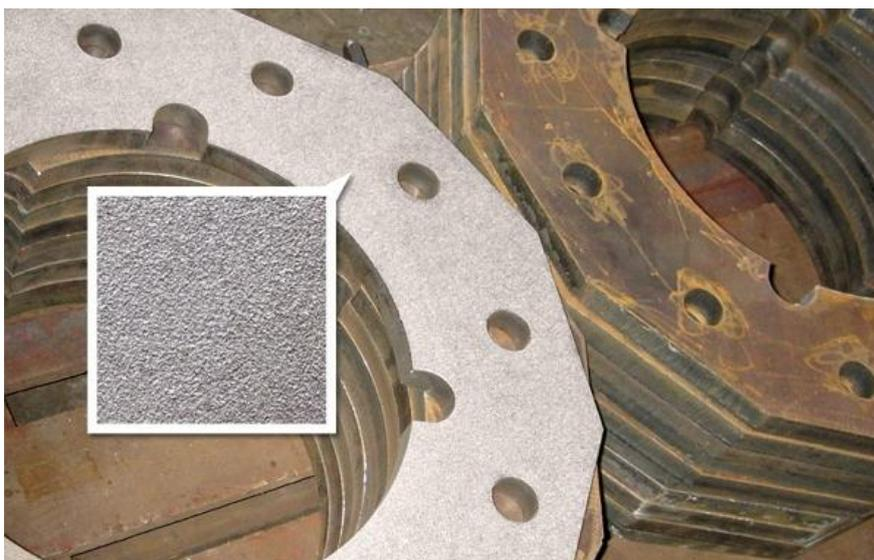
Рисунок 30 – Вид поверхности после обработки ультразвуком
