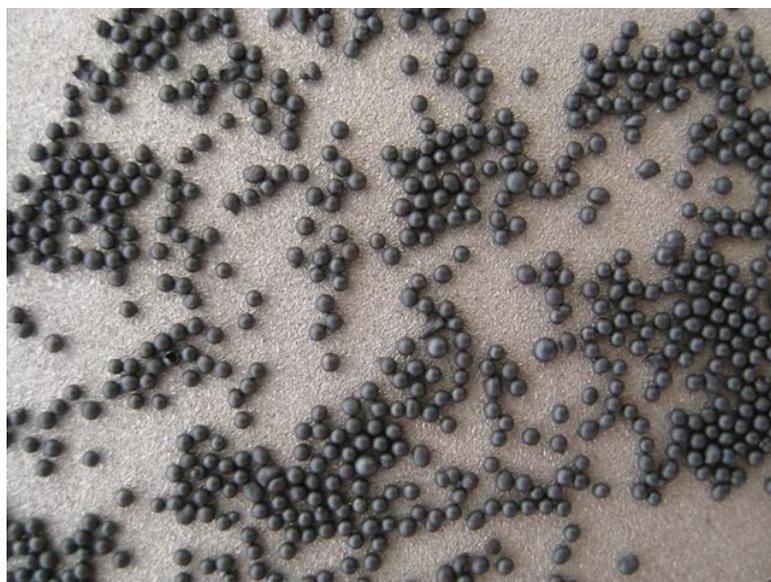
Рисунок 26 - Общий вид стальной и чугунной дроби
