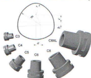
Рис.1. Конструкция и размеры конусов Capto [1]
