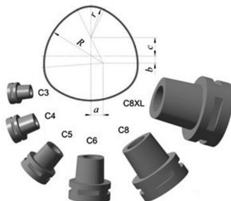
Рис. 1. Конструкция и размеры конусов Capto [1]
