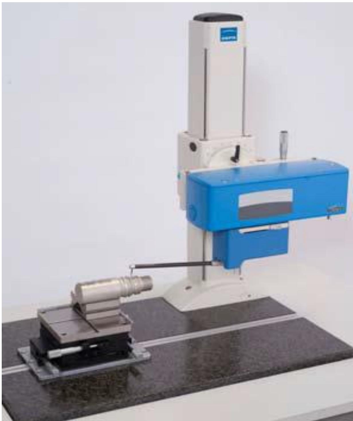
Рисунок 3.6 – Аппарат для контроля качества микрорельефа поверхности
