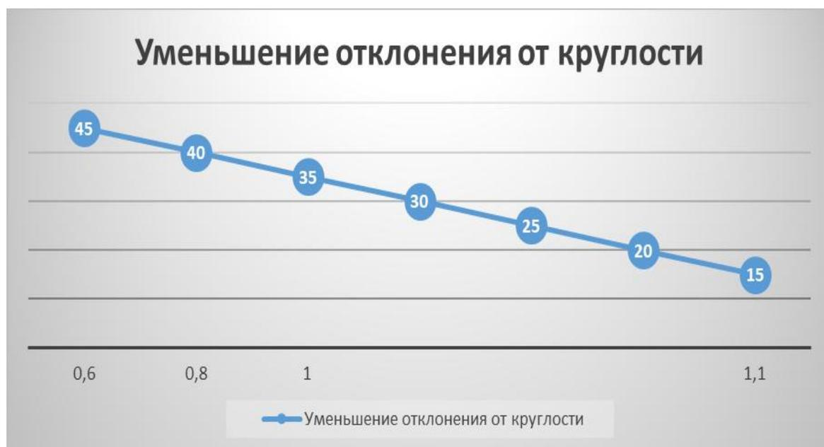
Рисунок 5.4 - Влияние круговой подачи на отклонение от круглости отверстия.
