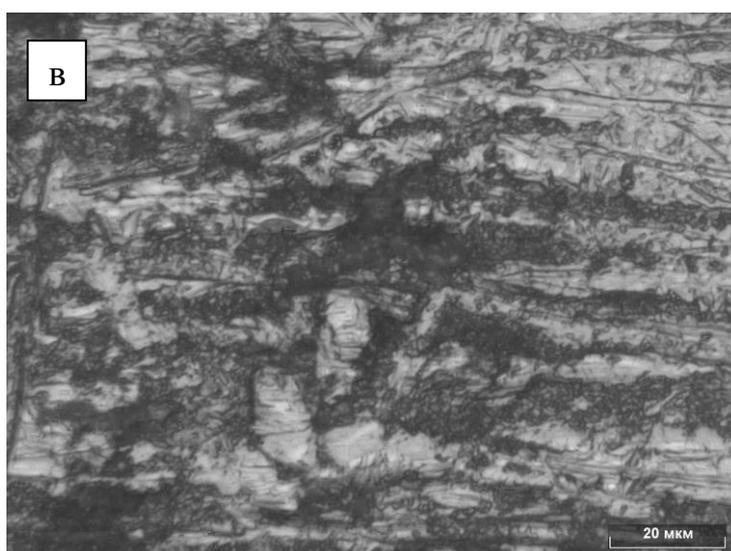
Рисунок 3.5 – Поверхность после коррозионного воздействия образцов из стали 10 после ИПДК на расстоянии R (а), 0,5 R (б) и 0 (в) от центра образца (металлография)
