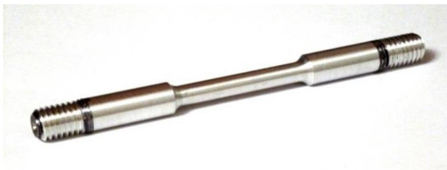
Рисунок 2.3 – Образец для испытания на растяжение
