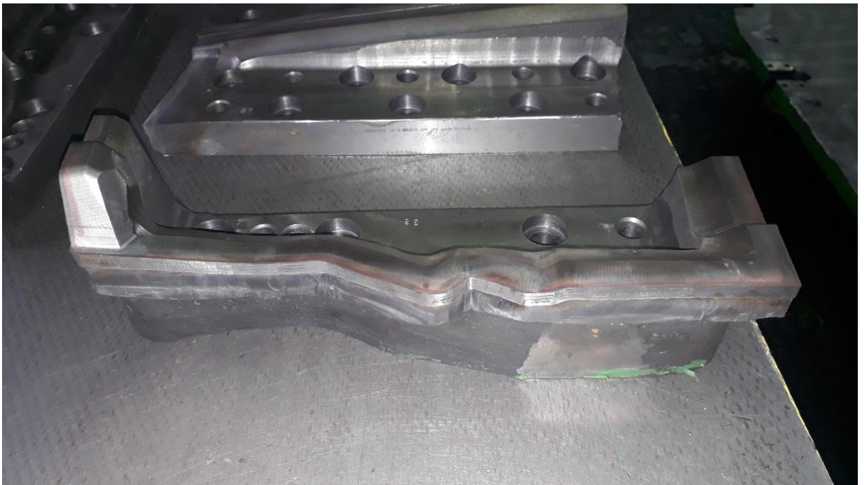
Рисунок 6.1 – Упрочненная секция после проведения газопламенной закалки.
