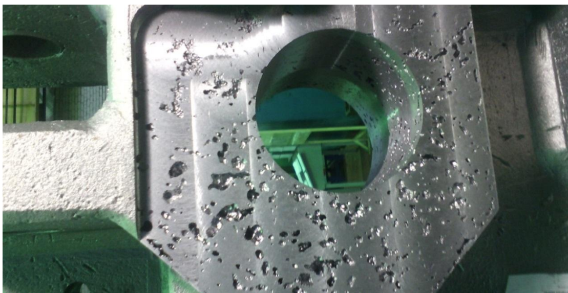
Рисунок 1.1 – Пример отливки низкого качества.
