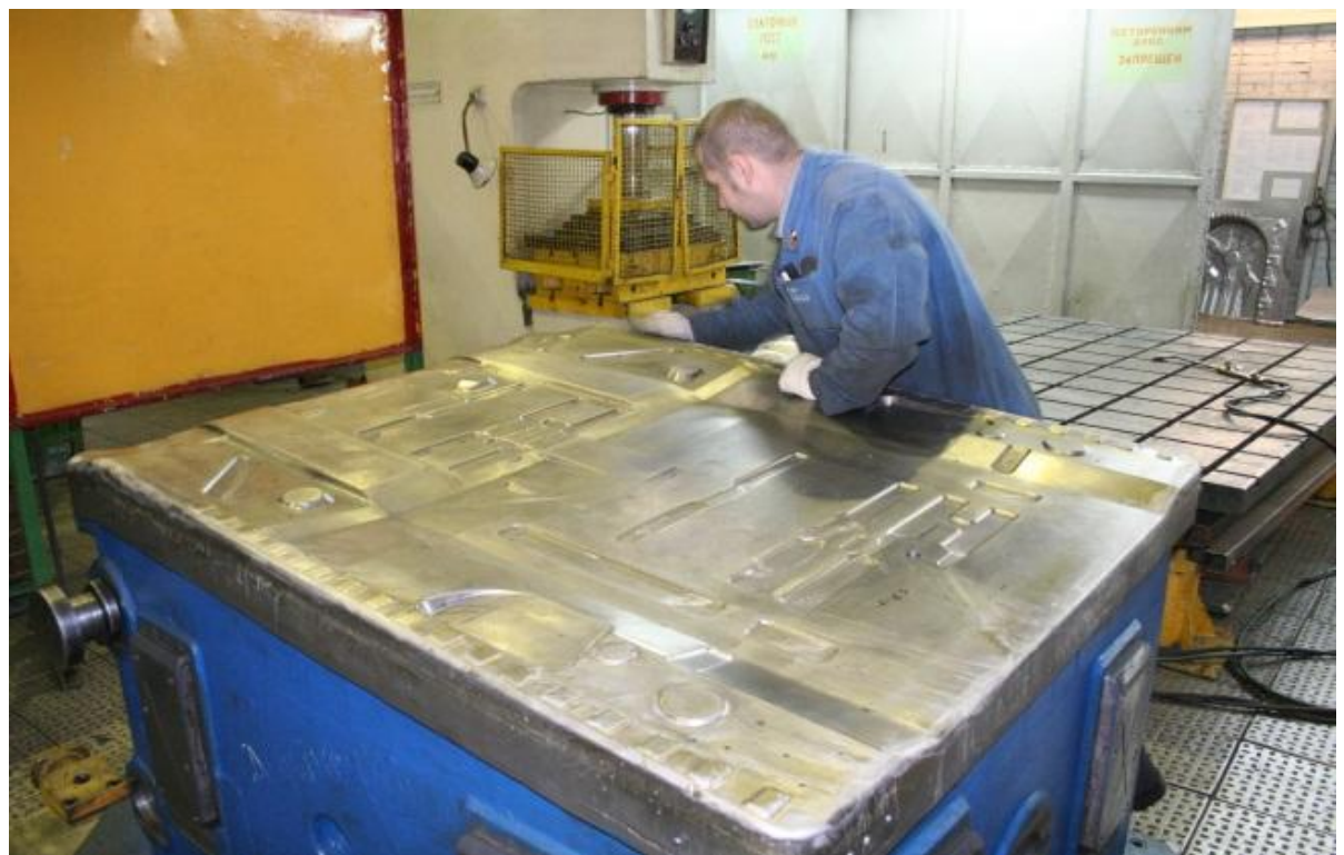
Рисунок 3.3 – Штамп «пол центральный»: матрица и пуансон.
