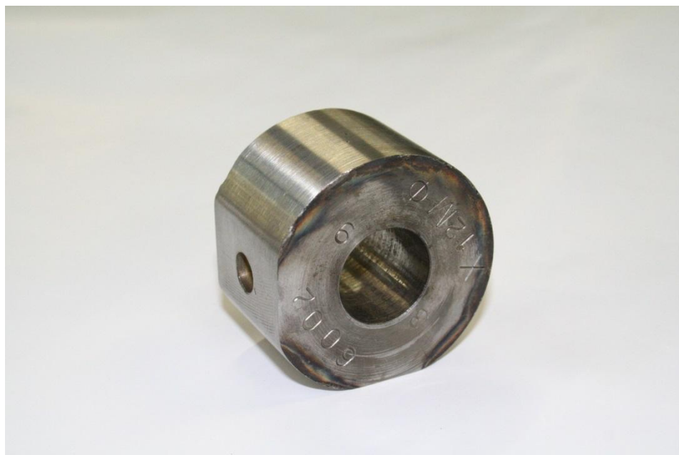
Рисунок 2.5 – Образец из стали X12MФ после проведения плазменной закалки и операции шлифования.
