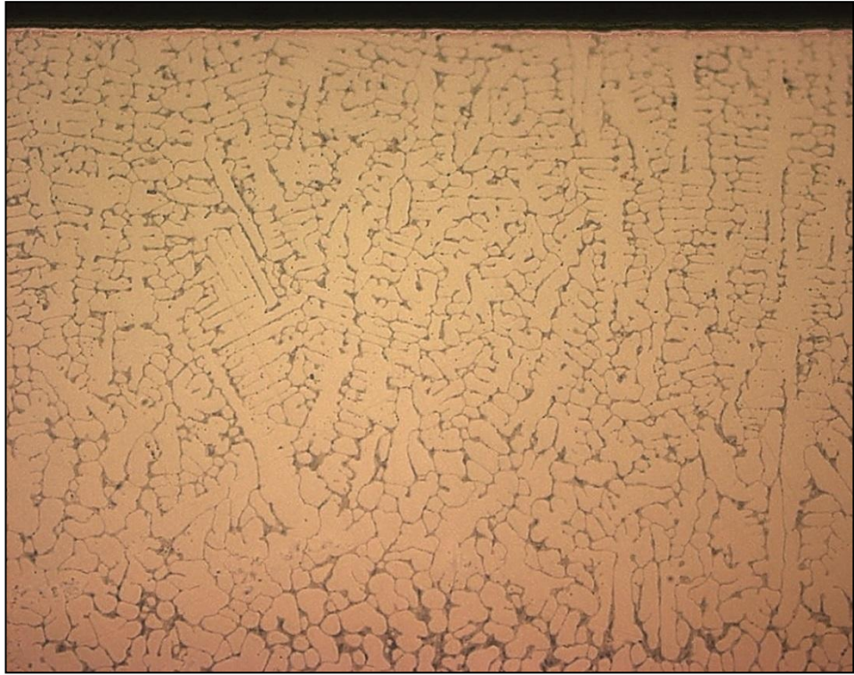
Рисунок 2.6 – Микроструктура упрочненного слоя образца из стали X12МФ ( \times 500 ).
