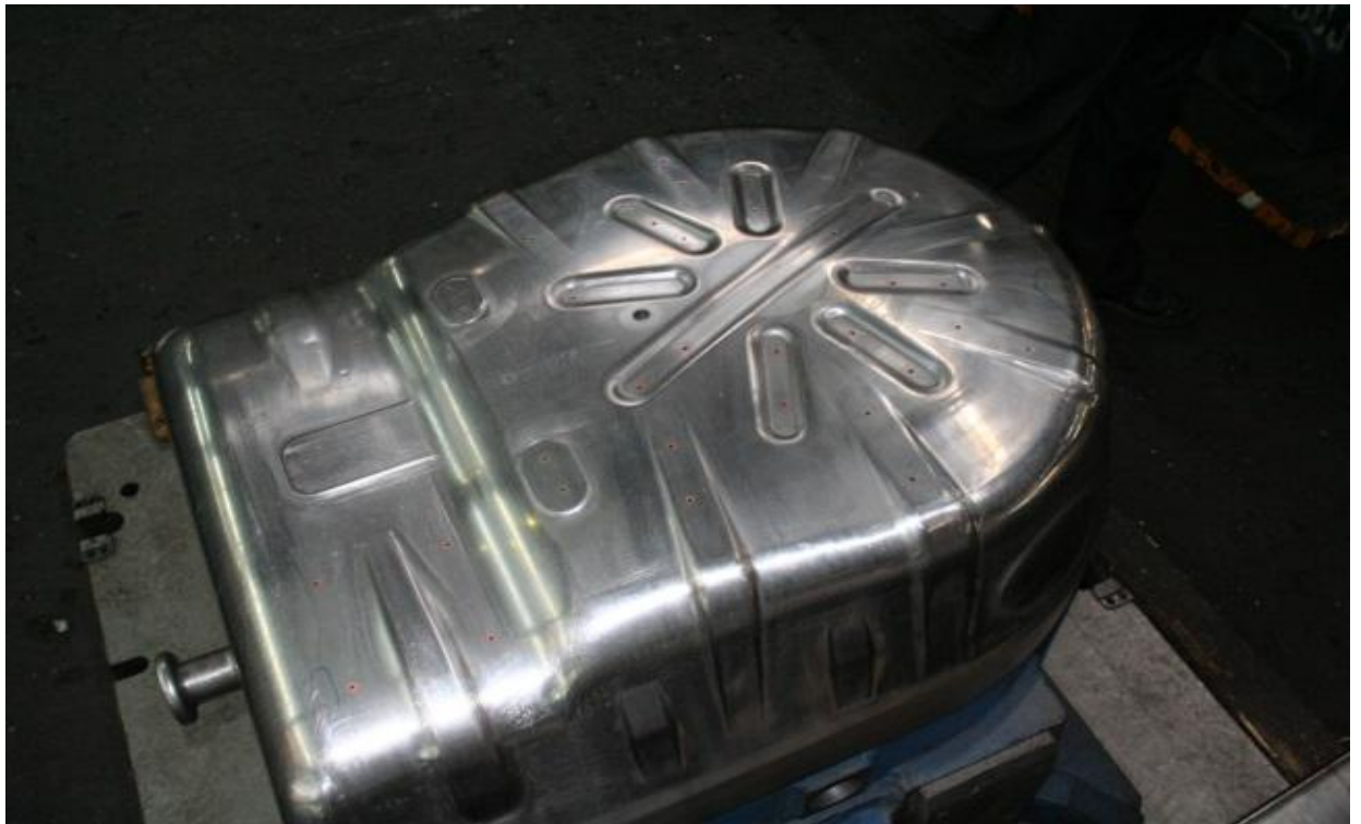
Рисунок 3.4 – Штамп «пол задний»: матрица и пуансон.
