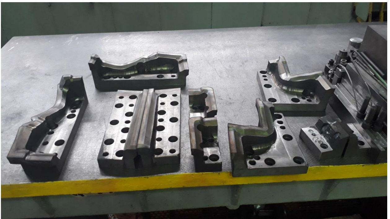
Рисунок 6.2 – Упрочненный комплект секций после проведения газопламенной закалки.
