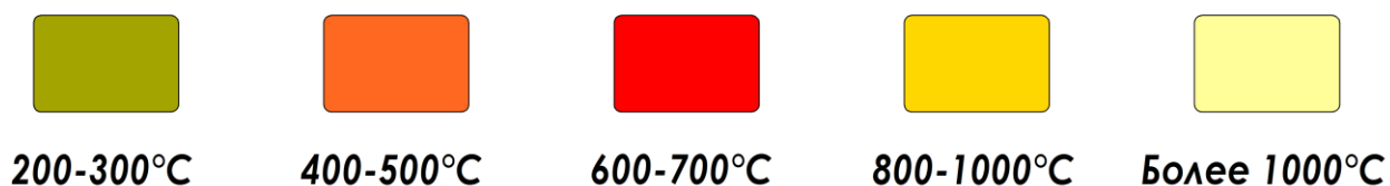
Рисунок 5.1 – Степень нагрева поверхности при пламенной закалке.
