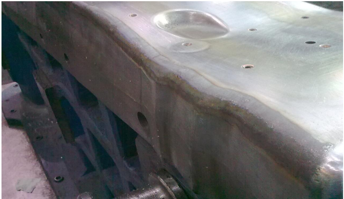
Рисунок 3.5 – Поверхность упрочненных участков штампов непосредственно после проведенной плазменной закалки.
