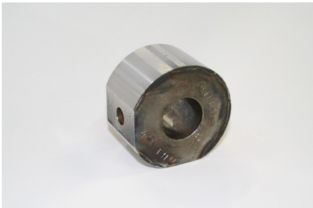
Рисунок 2.9 – Образец из стали 40Х после проведения плазменной закалки и операции шлифования.
