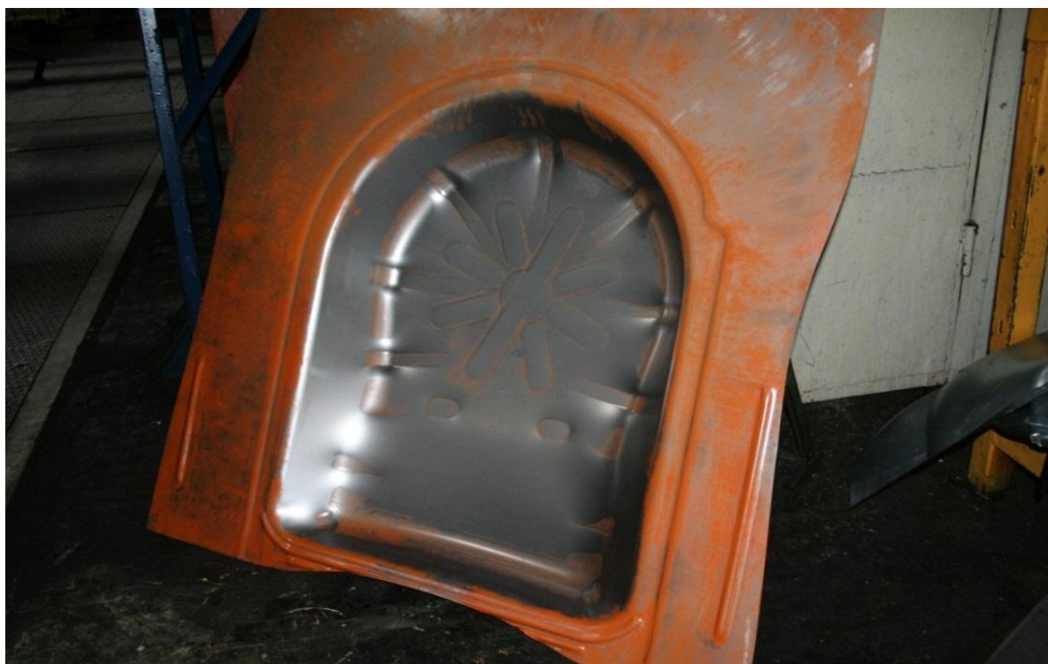
Рисунок 3.6 – Вытяжной переход детали «пол задний» с контролем качества штамповки «по краске».
