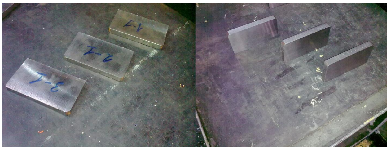
Рисунок 5.11 – Закаленные образцы. Материал – чугун ХФ.
