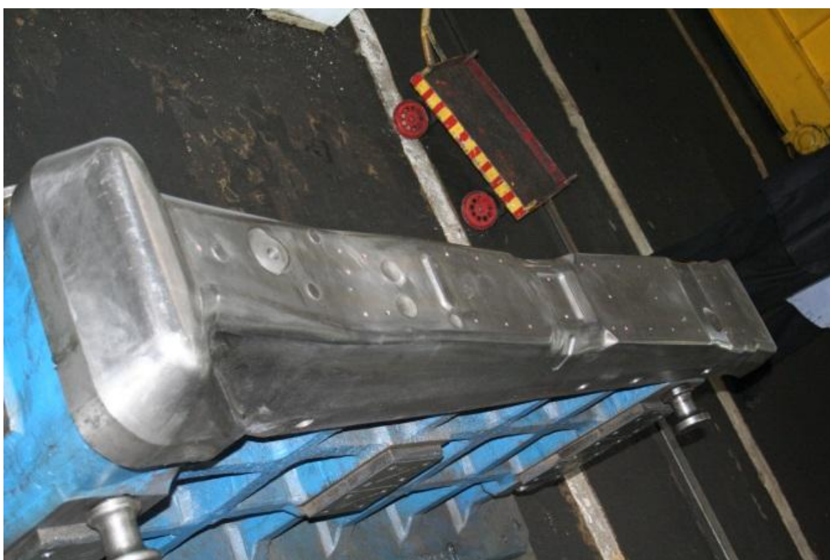
Рисунок 3.2 – Штамп «тоннель пола»: матрица и пуансон.
