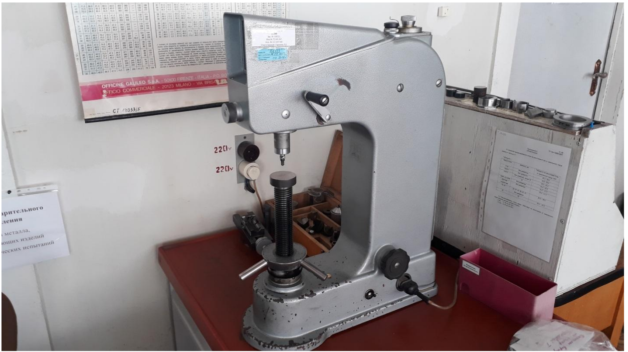
Рисунок 5.3 – Твердомер Роквелл ТК-3-1.
