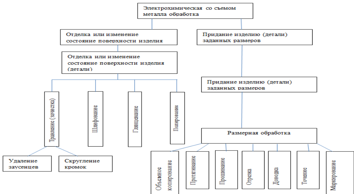
Рисунок 3 - Виды анодного растворения материала со съемом металла
