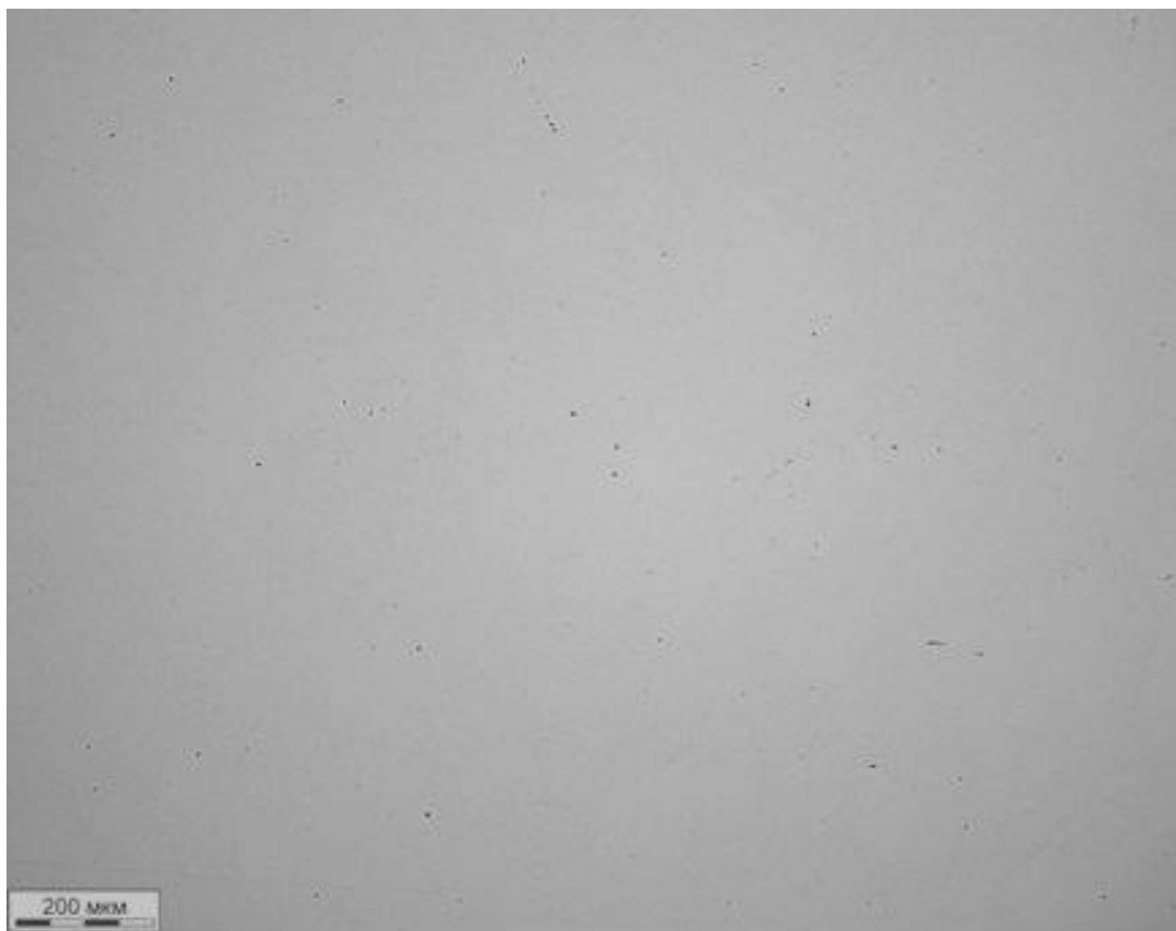
Рисунок 2.2 – Неметаллические включения материала корпуса задвижки, сталь 13ХФА
