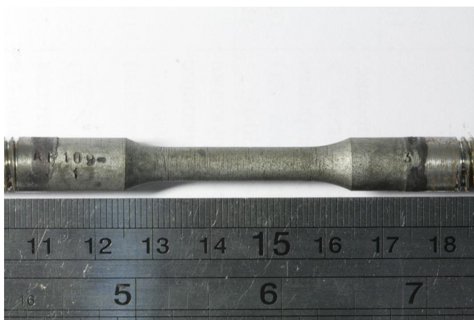
Рисунок 2.9 – Внешний вид образцов после испытаний на СКРН
