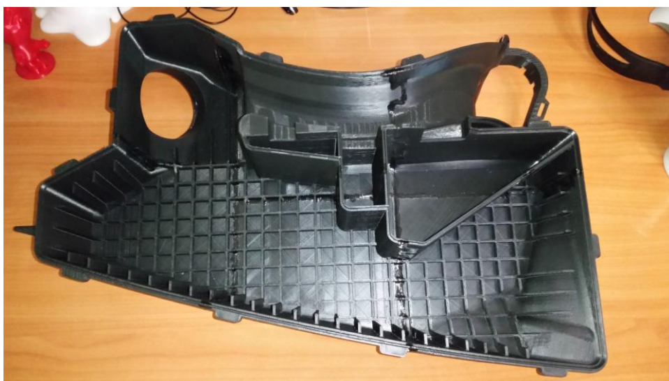
Рисунок 30 - Нижняя часть резонатора воздушного фильтра из ABS-пластика
