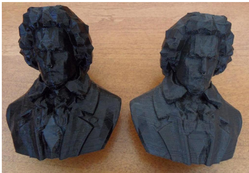
Рисунок 1 - Слева изделие из пластика PLA и справа из пластика ABS
