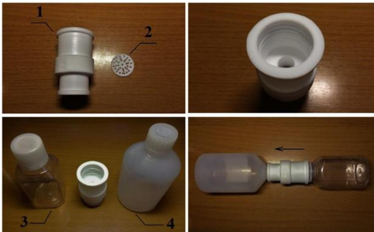
Рисунок 14 – Общий вид переходника (1 – переходник; 2 – основание для фильтра; 3 – подающая бутылка; 4 – принимающая бутылка)
