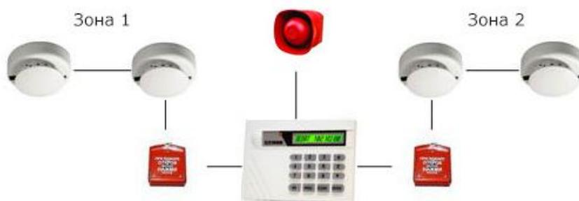
Рисунок 6 – Неадресная система автоматической пожарной сигнализации
