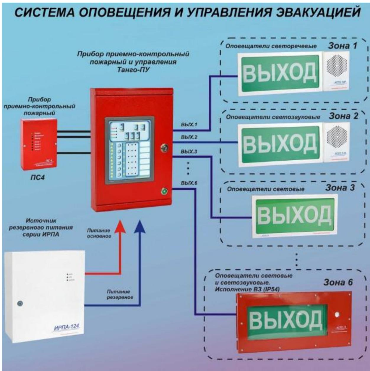
Рисунок Г 1 - Система оповещения и управления эвакуацией ГБОУ школы-интерната № 5 города Тольятти
