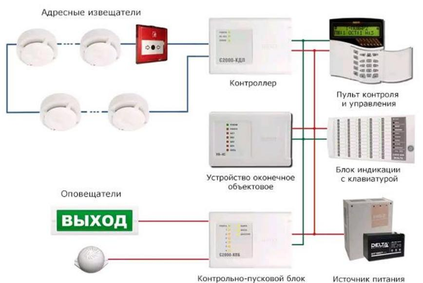
Рисунок 7 – Адресно-аналоговая система автоматической пожарной сигнализации
