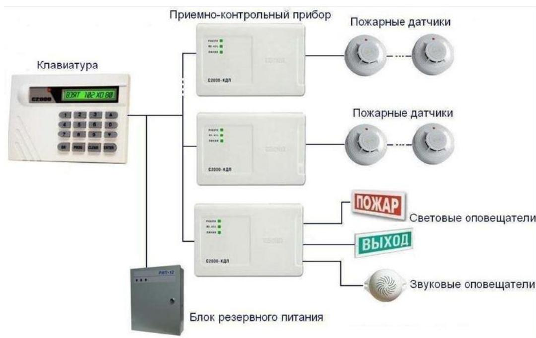
Рисунок 5 – Автоматическая пожарная сигнализация (АПС) и ее компоненты
