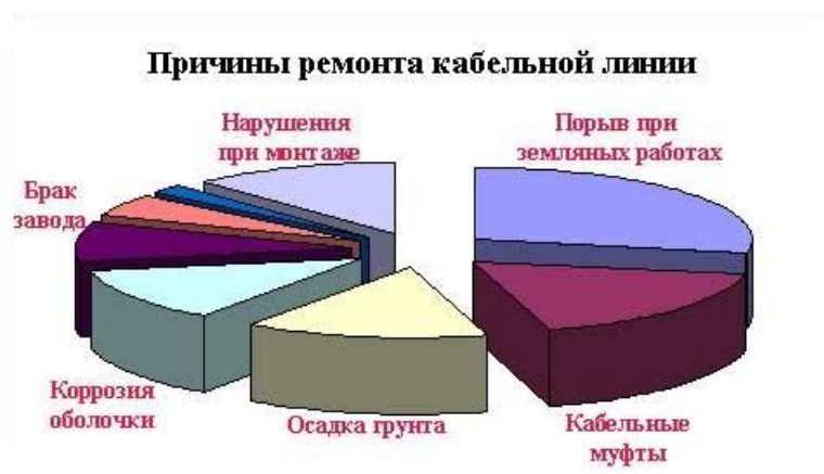
Рисунок 3 - Причины ремонта кабельной линии
