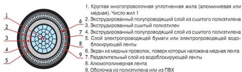
Рисунок 6 - кабель силовой с полимерной изоляцией с продольной герметизацией
