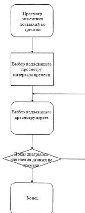
Рисунок В.12 – Блок-схема последовательности этапов просмотра предыдущих данных в программном обеспечении для управления данными в системе оповещения
