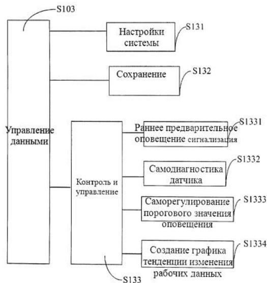
Рисунок В.10 – Блок-схема этапов при управлении данными в способе оповещения
