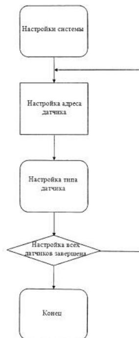
Рисунок В.11 – Блок-схема последовательности этапов настройки в программном обеспечении для управления данными в системе оповещения
