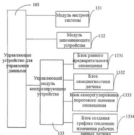
Рисунок В.2 – Основная структурная диаграмма управляющего устройства для управления данными в системе оповещения
