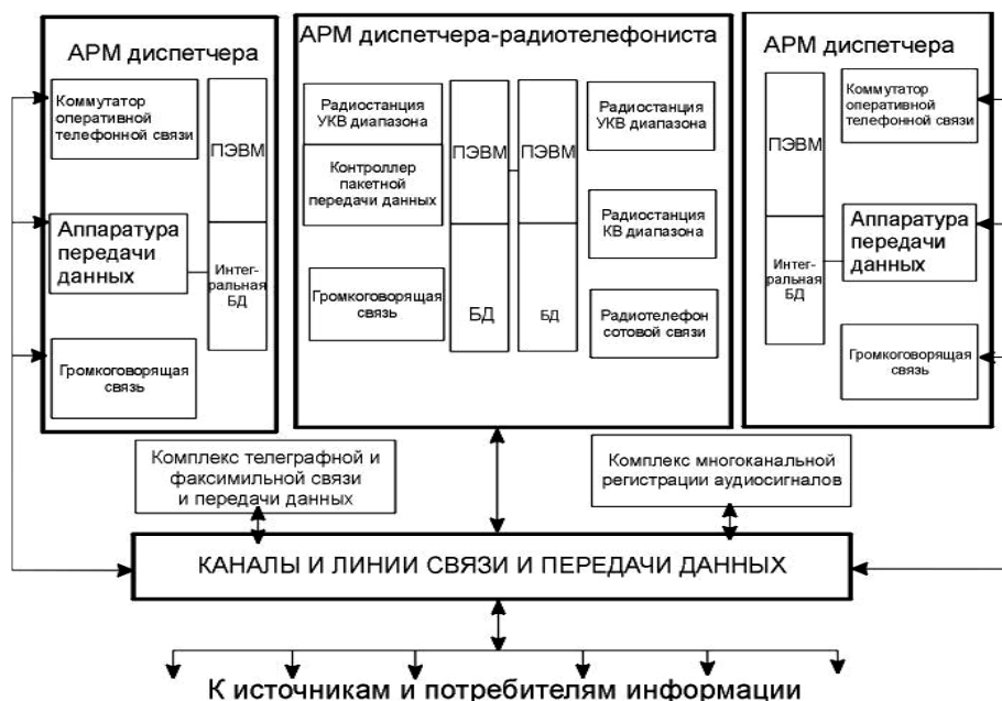
Рисунок 3 – Комплекс технических средств ЦУС
