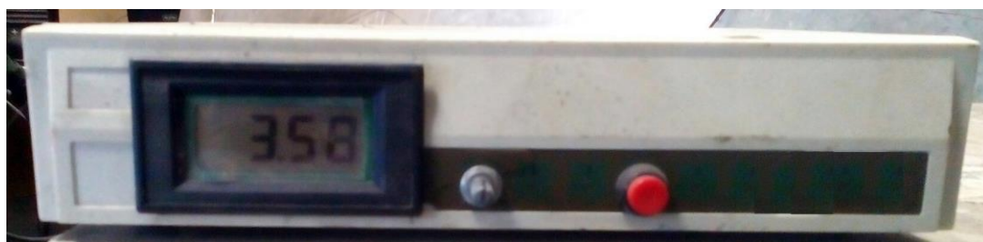
Рисунок 4.12 – Блок управления подачей напыляемой проволоки.
