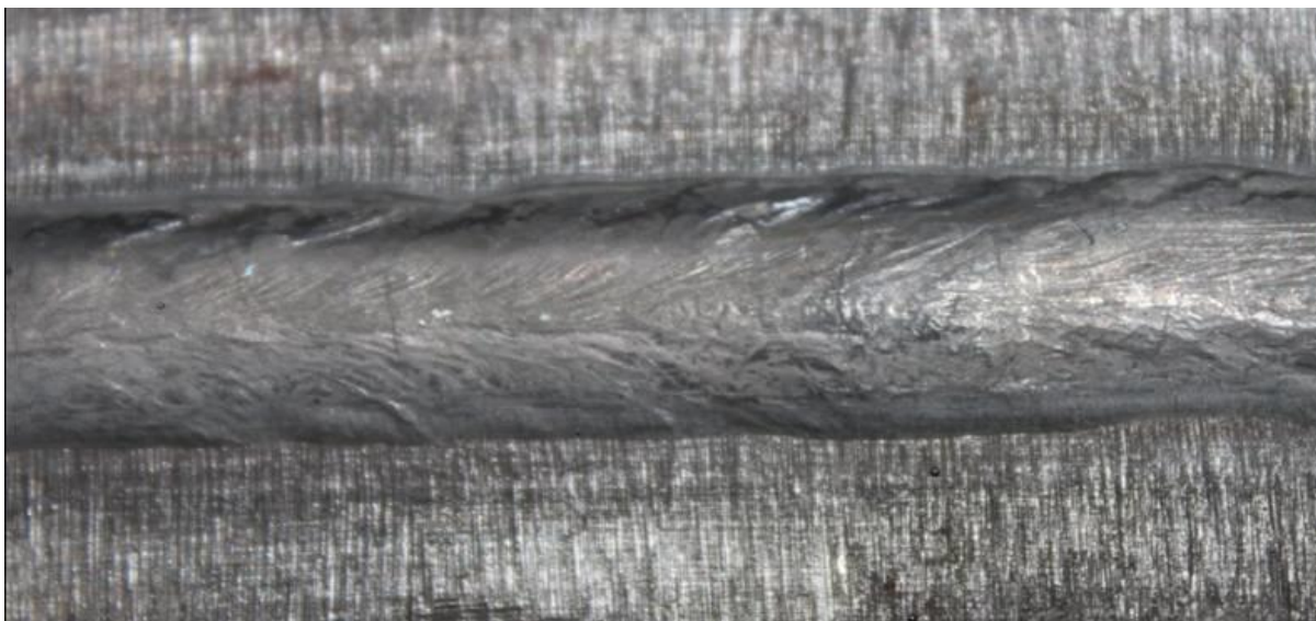
Рисунок 5.1 – Внешний вид наплавленного шва способом аргодуговой наплавки неплавящимся электродом.
