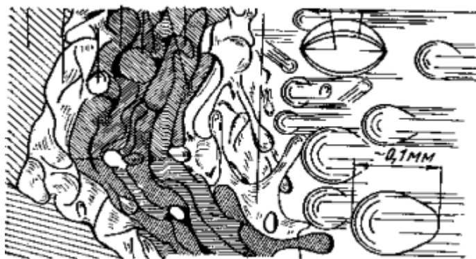
Рисунок 2.7 – Процесс формирования покрытия.
