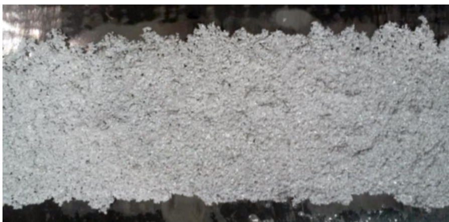
Рисунок 5.15 – Покрытие сформированное методом напыления сжатой дугой.
