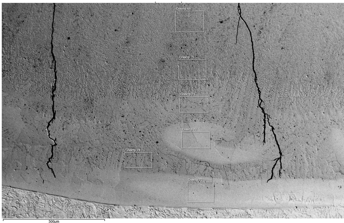
Рисунок 5.13 – Структура наплавленного металла образца №7 (Al = 31,65 %).
