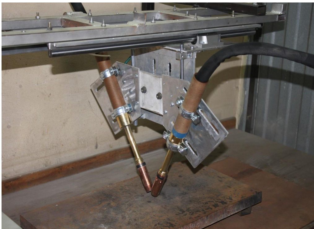
Рисунок 4.6 – Установка для автоматической двухдуговой наплавки.
