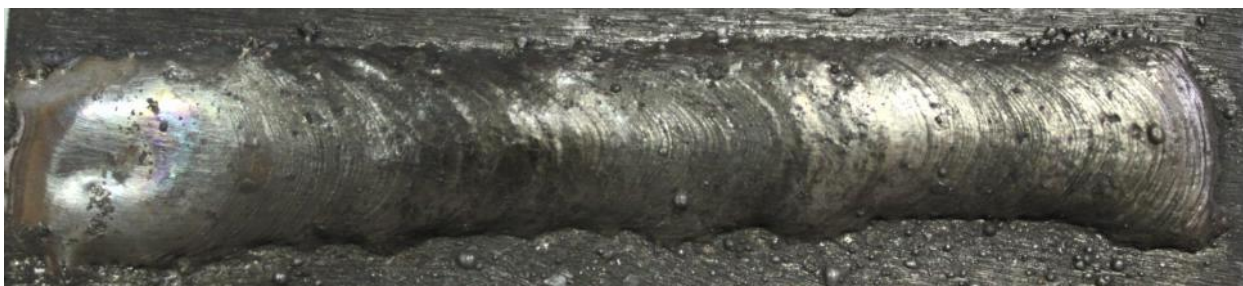
Рисунок 5.7 – Внешний вид наплавленного шва способом двухдуговой наплавки.
