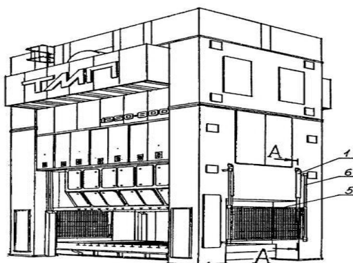
Рисунок 4.1 - общий вид защитного устройства штамповой зоны, установленного на боковой поверхности стоек механического пресса
