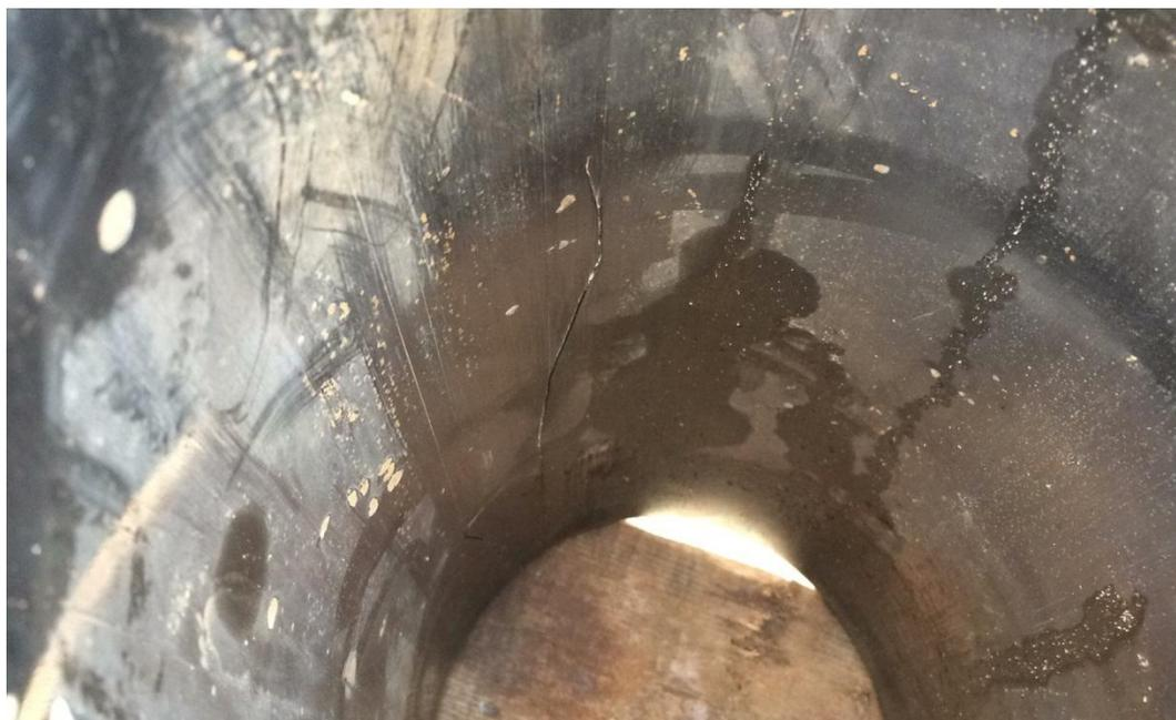
Рисунок 1.5.4 – Трещины втулки цилиндрической
