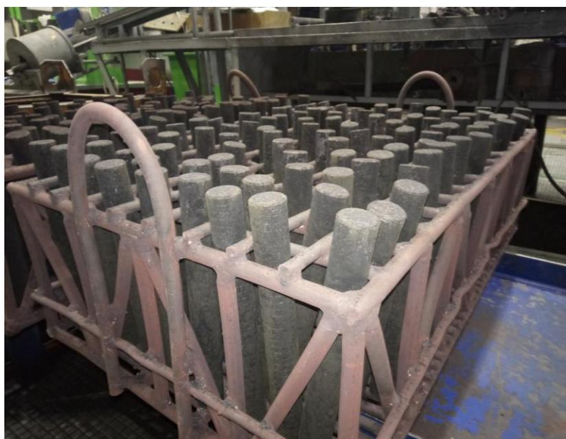
Рисунок 4.1.2 – Цилиндрические образцы после азотирования, охлаждения в масле и промывки
