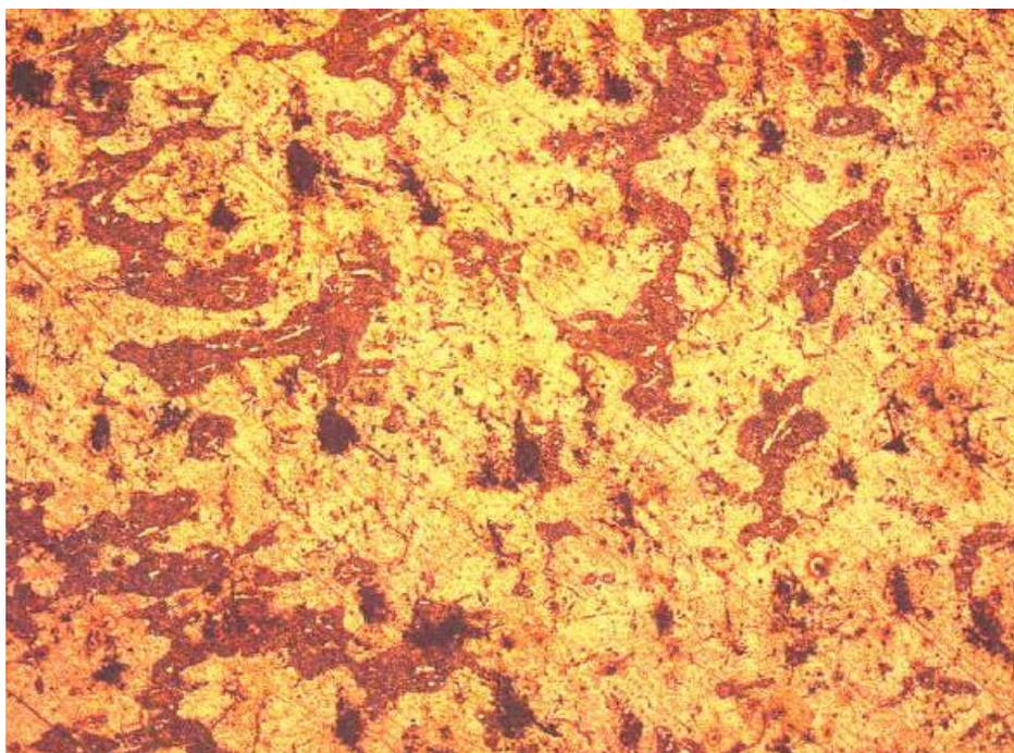
Рисунок 1.5.7 – Микроструктура слоя 1. Увеличение x100. Чугун серый с пластинчатым и вермикулярным графитом П20 (Ф80)
