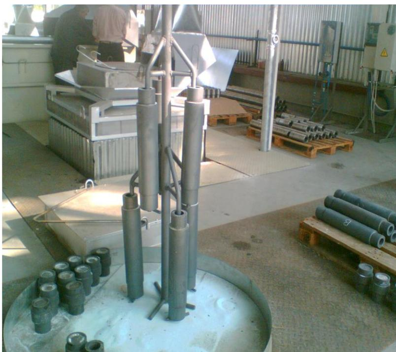
Рисунок 4.1.1 – Пример расположения в садке втулки цилиндрической на установке «Корунд»
