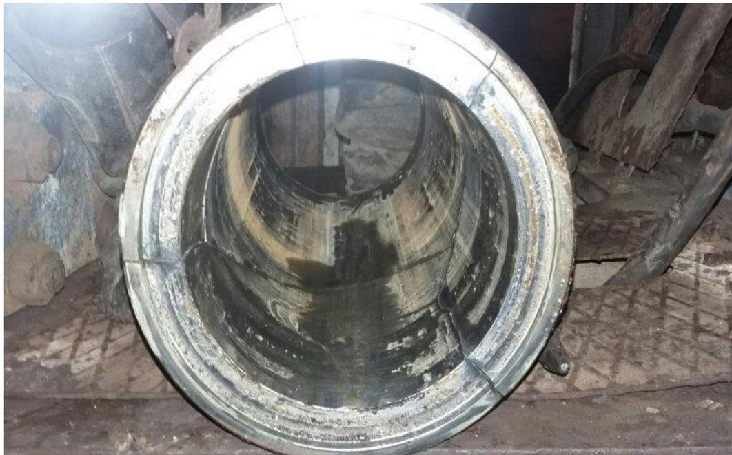
Рисунок 1.5.3 – Разрушение втулки в буровом насосе
