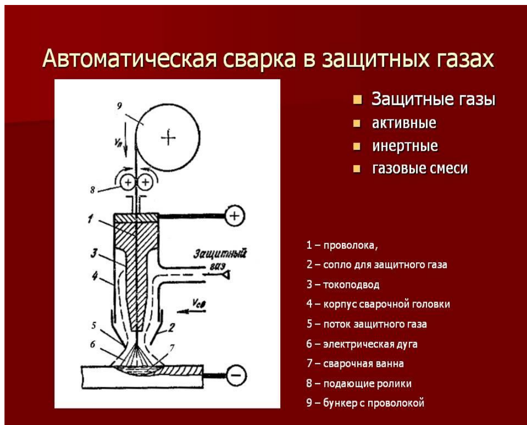
Рисунок 8 - Автоматическая сварка в защитных газах
