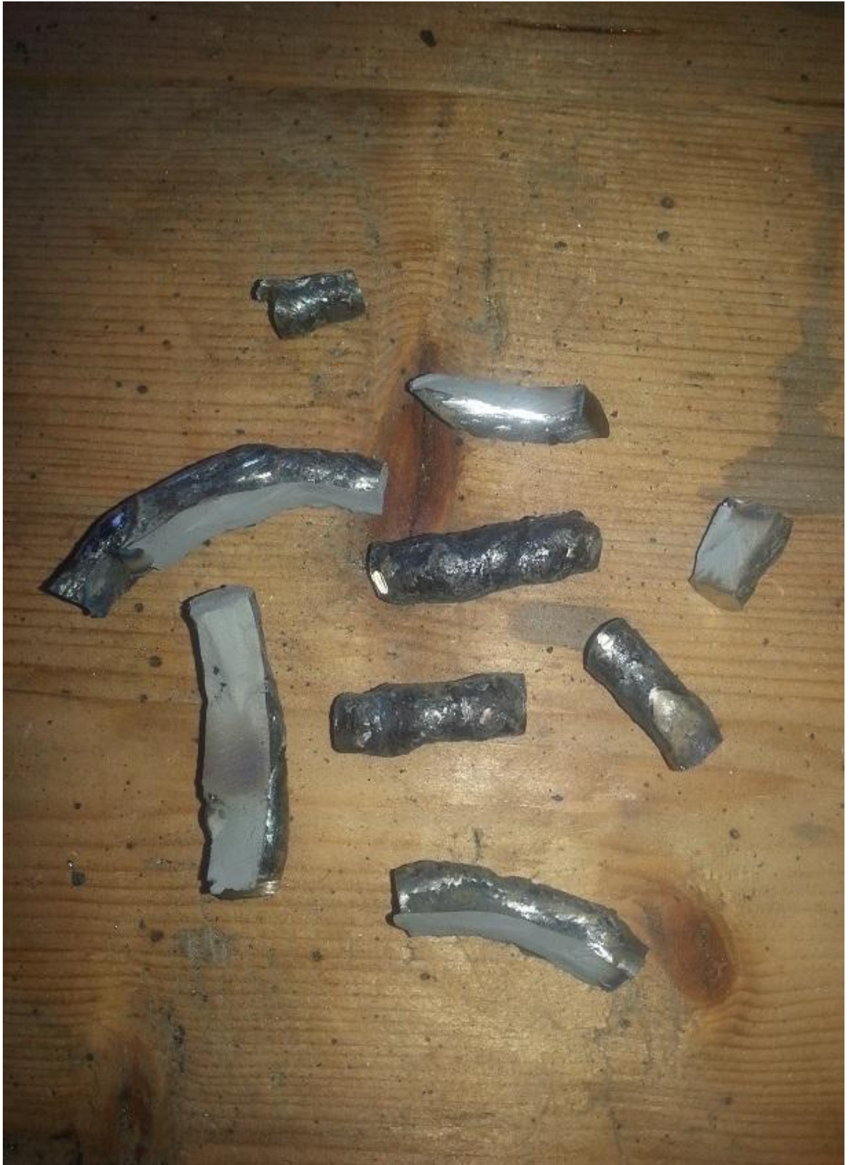
Рисунок 32 - Внешний вид наплавленного шнека с дефектами: трещины (а), сколы (б)
