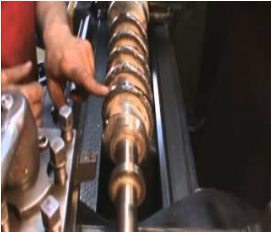
Рисунок 38 - Внешний вид наплавленного шнека перед обработкой на токарном станке
