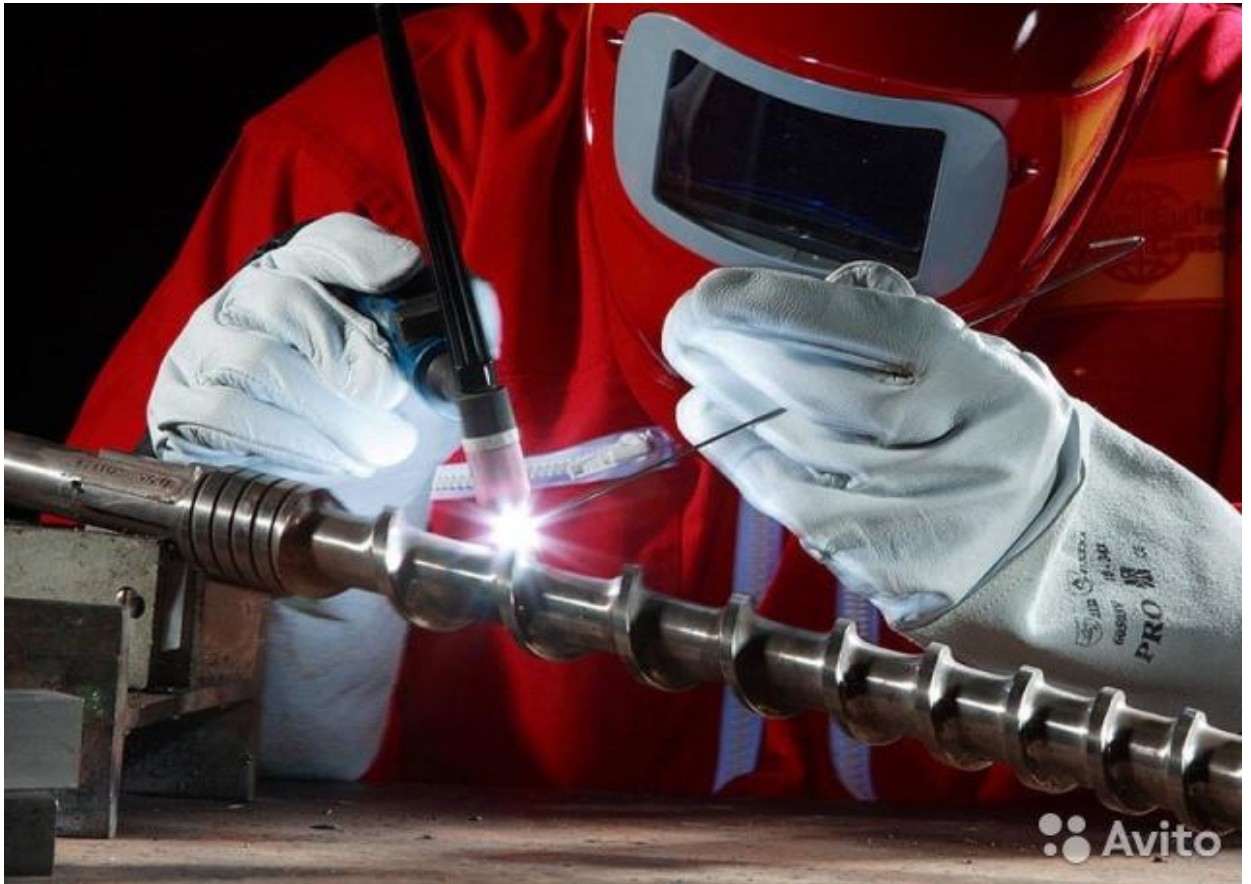
Рисунок 5 - Дуговая наплавка W-электродом в аргоне
