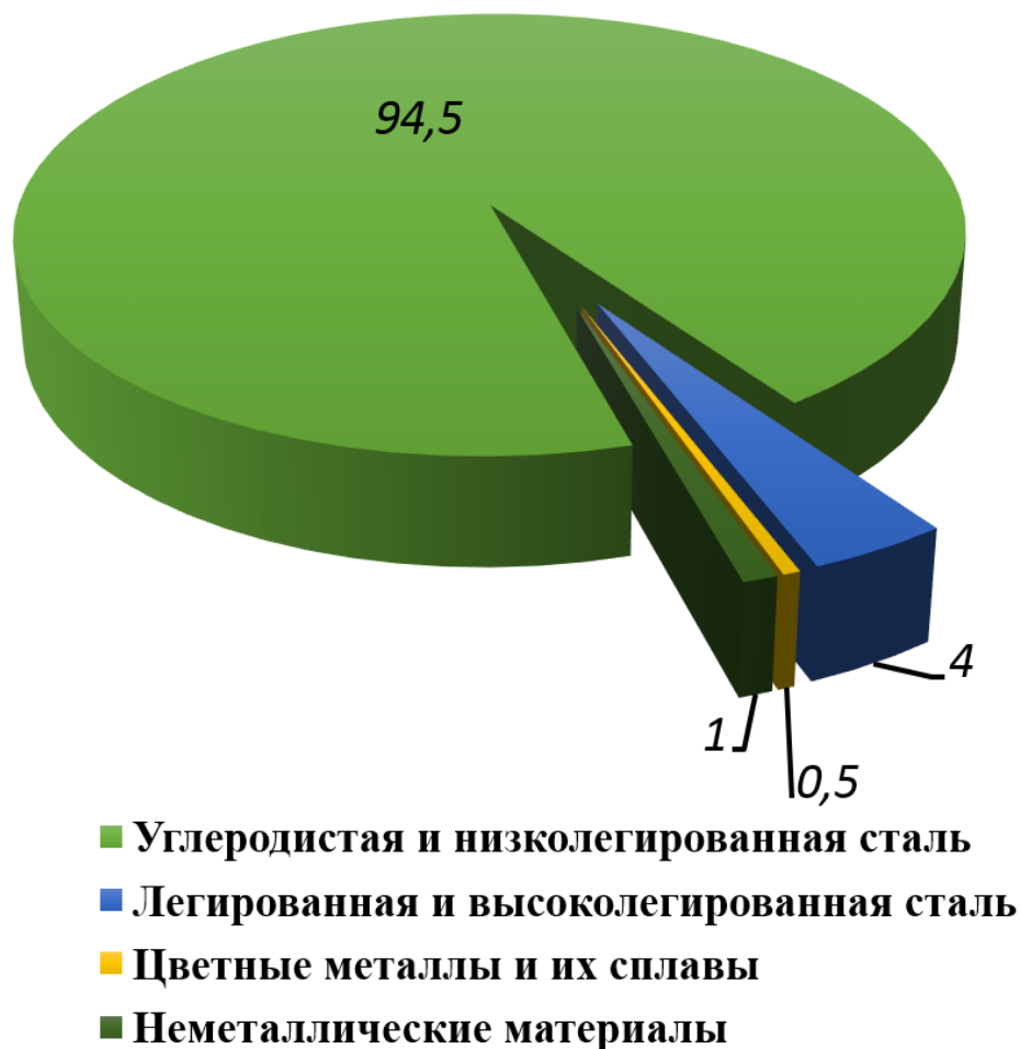
Рисунок 1.5 – Диаграмма соотношения применения различных материалов в промышленном строительстве
