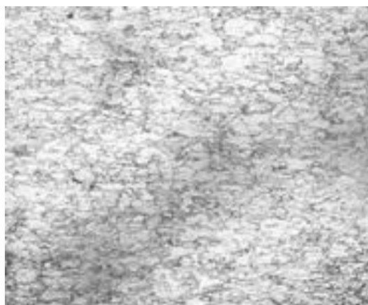
Рисунок 4.4 – Структура основного металла образца К4
