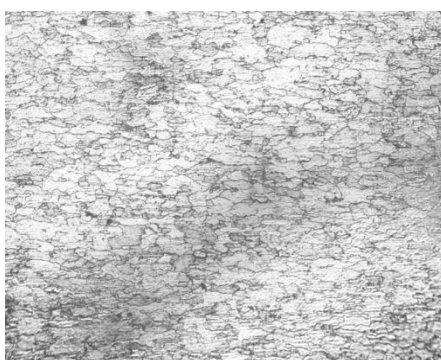
Рисунок 4.8 – Структура основного металла образца К5
