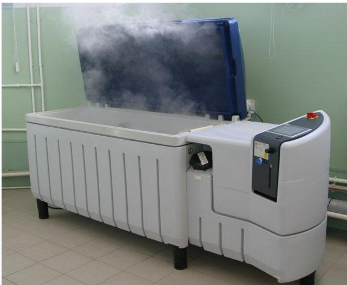
Рисунок 29 – Камера нейтрального соляного тумана WEISS TECHNIK SC1000
