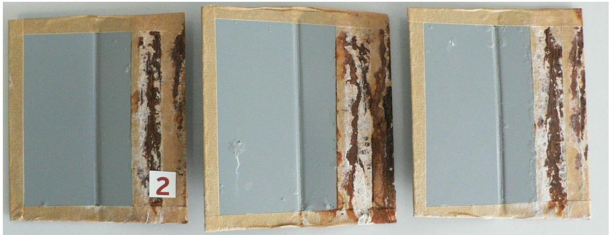
Рисунок 36 – Внешний вид паяных швов в соединении кузовных сталей марки 01ЮТ ГЦ + 01ЮТ ГЦ после 1500 часов испытаний в нейтральном соляном тумане
