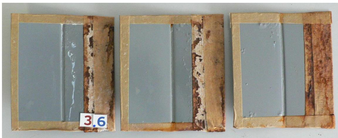
Рисунок 38 – Внешний вид паяных швов в соединении кузовных сталей марки 08Ю + 01ЮТ ГЦ с абразивной обработкой шва после 1500 часов испытаний в нейтральном соляном тумане
