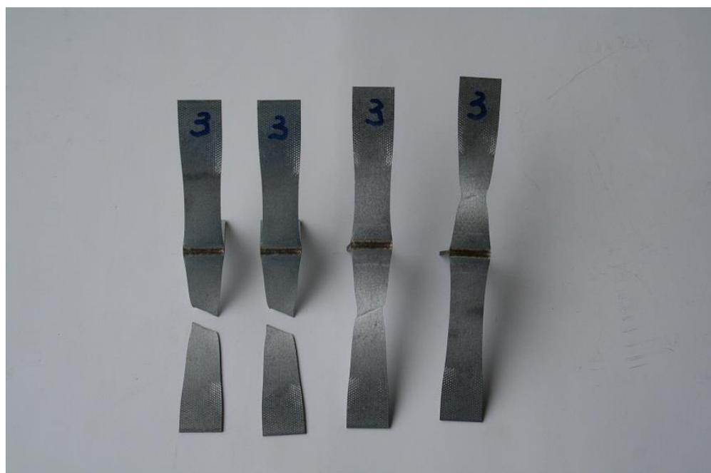
Рисунок 33 – Паяные образцы 01ЮТ ГЦ + 01ЮТ ГЦ после испытаний на разрыв
