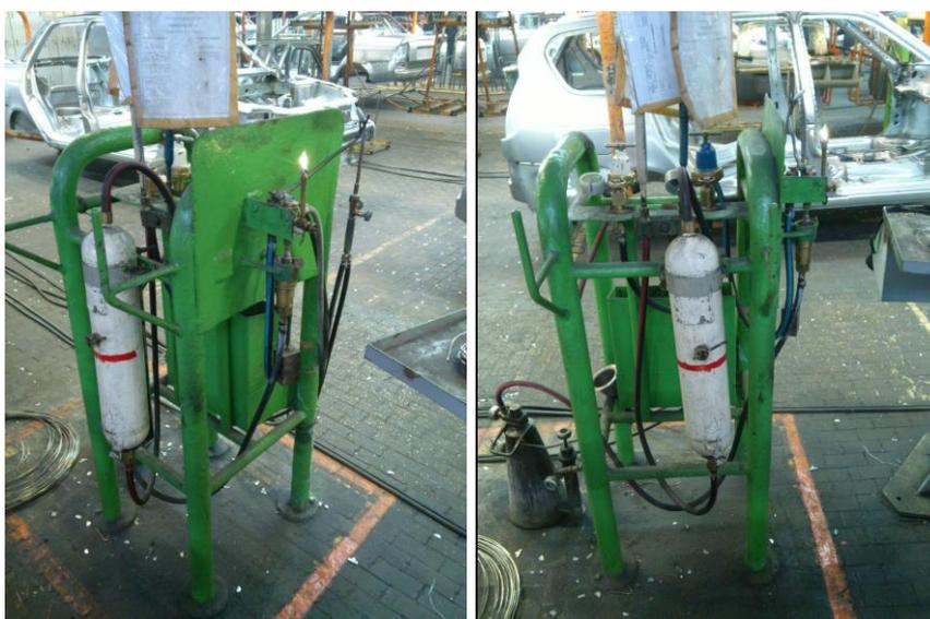
Рисунок 7 – Пост ацетилено-кислородной пайки
