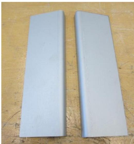
Рисунок 23 – Внешний вид образцов до пайки
