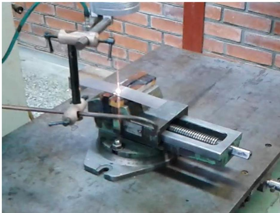
Рисунок 20 – Стенд сборки под пайку
