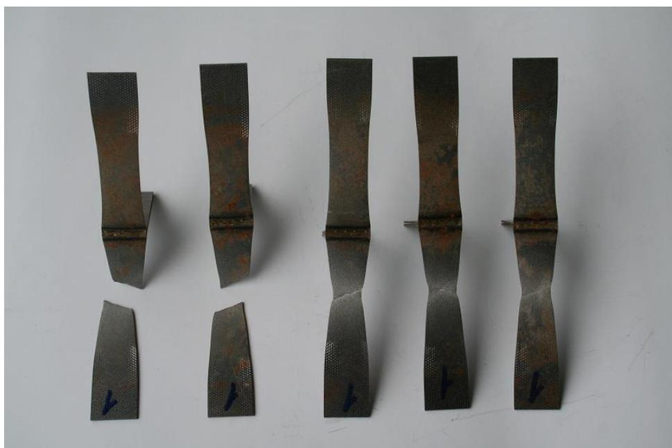
Рисунок 31 – Паяные образцы 08Ю+08Ю после испытаний на разрыв
