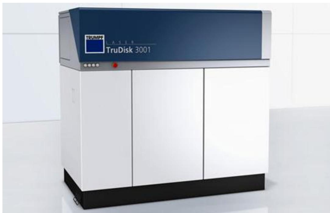
Рисунок 24 – Дисковый лазер TruDisk 3001
