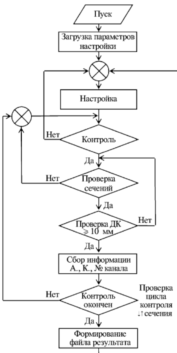
Рисунок 4.1 – Упрощенный алгоритм программного обеспечения 1 такта 1 канала.
