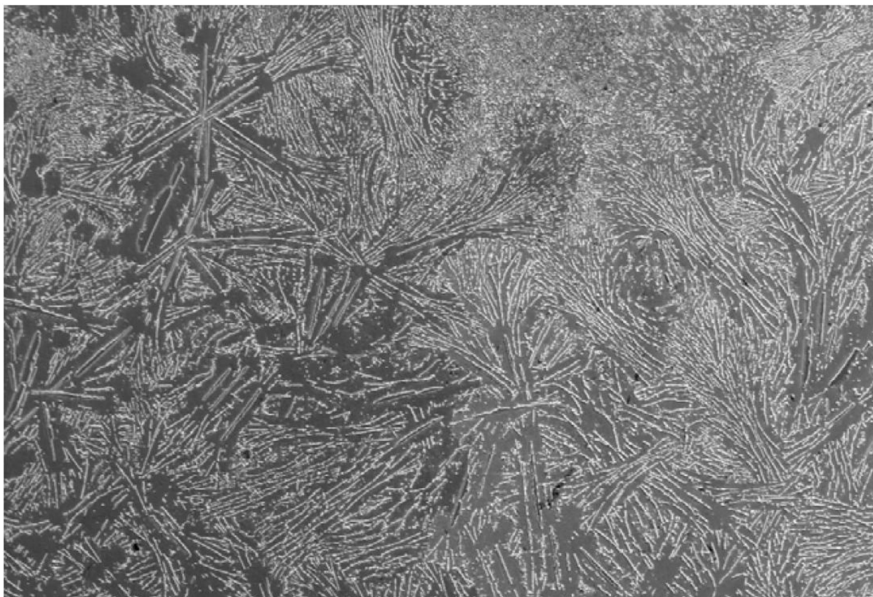
Рисунок 8 - Структура припоя Sn-2,5Ag-0,7Cu-0,15Ge ( \times 300 )
