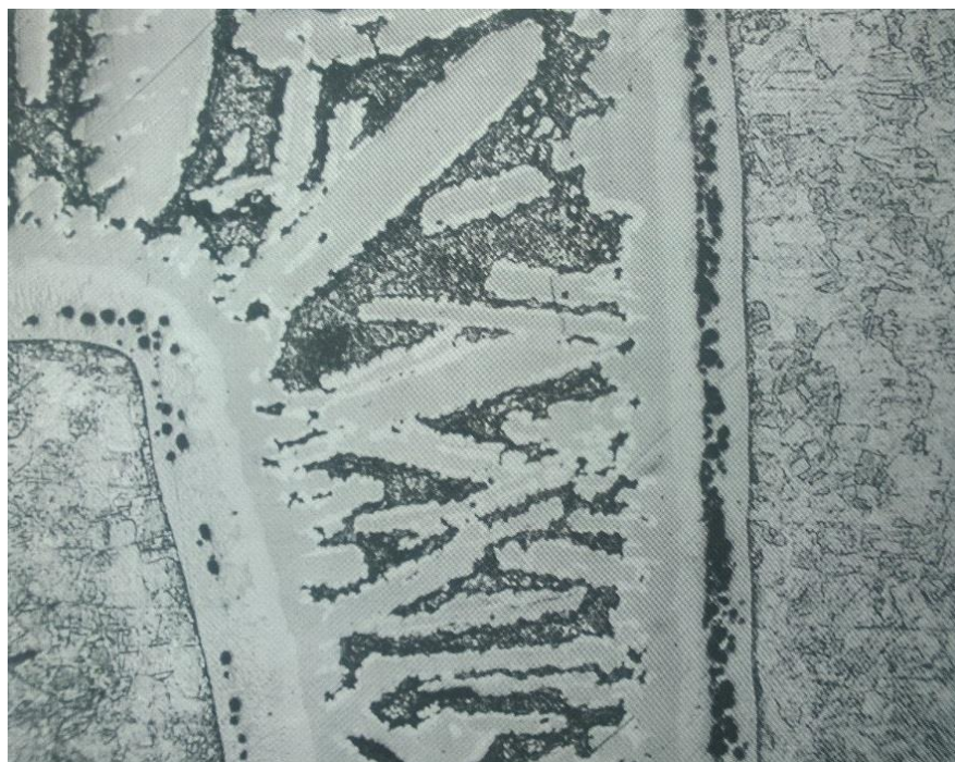
Рисунок 24 – Структура гальтельного участка паяного шва (x600)
