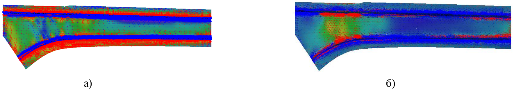
Рисунок 70 – Распределение сжимающих (синие) и растягивающих (красные) напряжений в верхнем слое: а) после обрезки, б) после разгрузки
