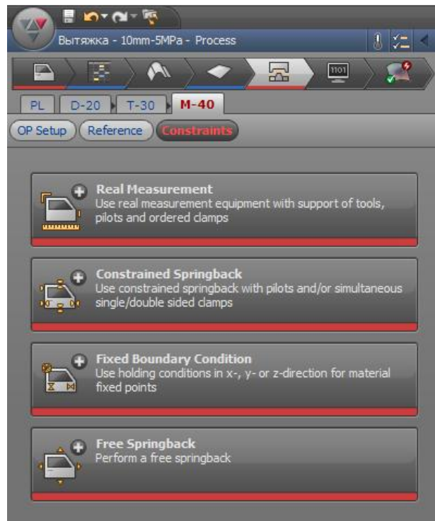
Рисунок 25 – Типы закрепления при измерении пружинения
