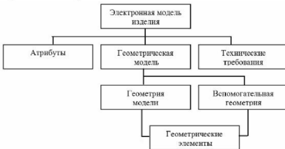
Рисунок 4 - Схема состава электронной модели изделия
