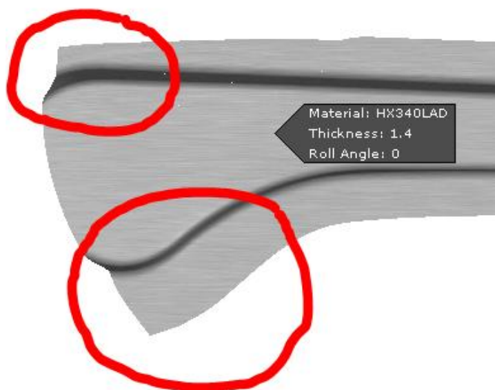
Рисунок 2 – Перетягивание материала в процессе вытяжки
