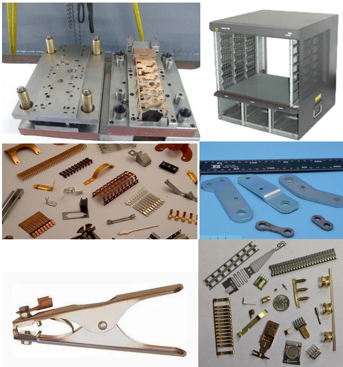
Рисунок 1.1 – Детали, получаемые штамповкой в электротехнической промышленности
