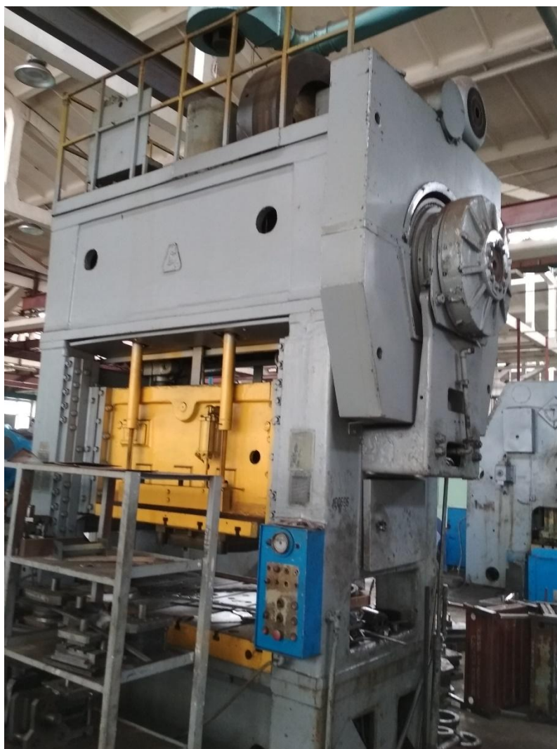
Рисунок 3.2 – Пресс двухкровошипный простого действия открытый K3132A
