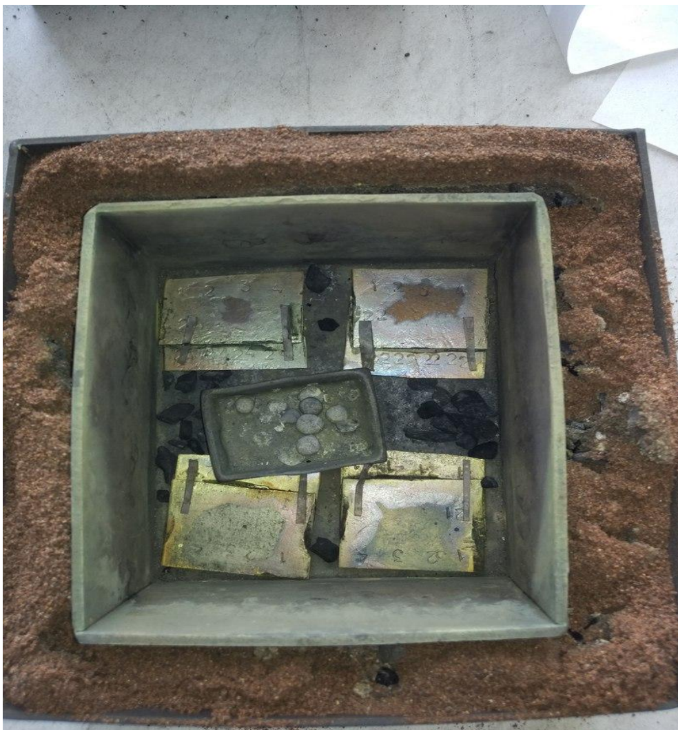
Рисунок 2.15 – Образцы после пайки, 6 опыт
