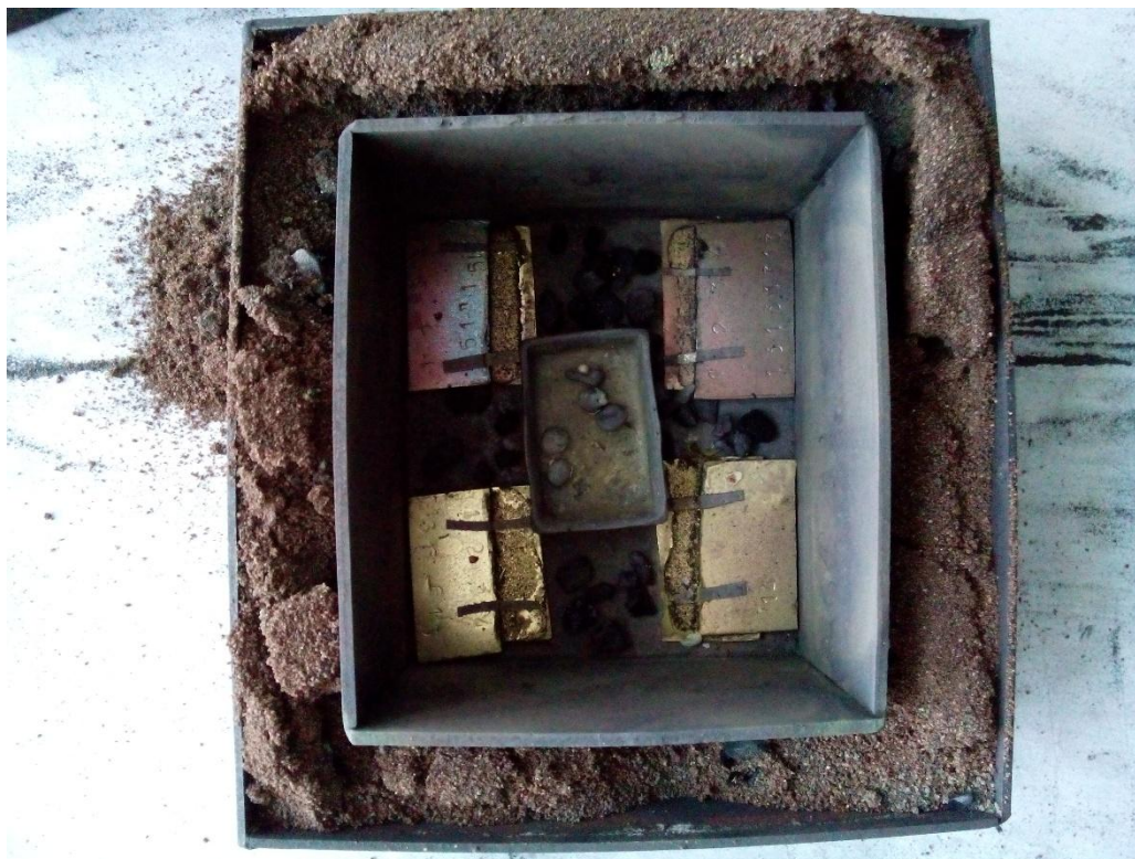
Рисунок 2.13 – Образцы после пайки, 5 опыт
