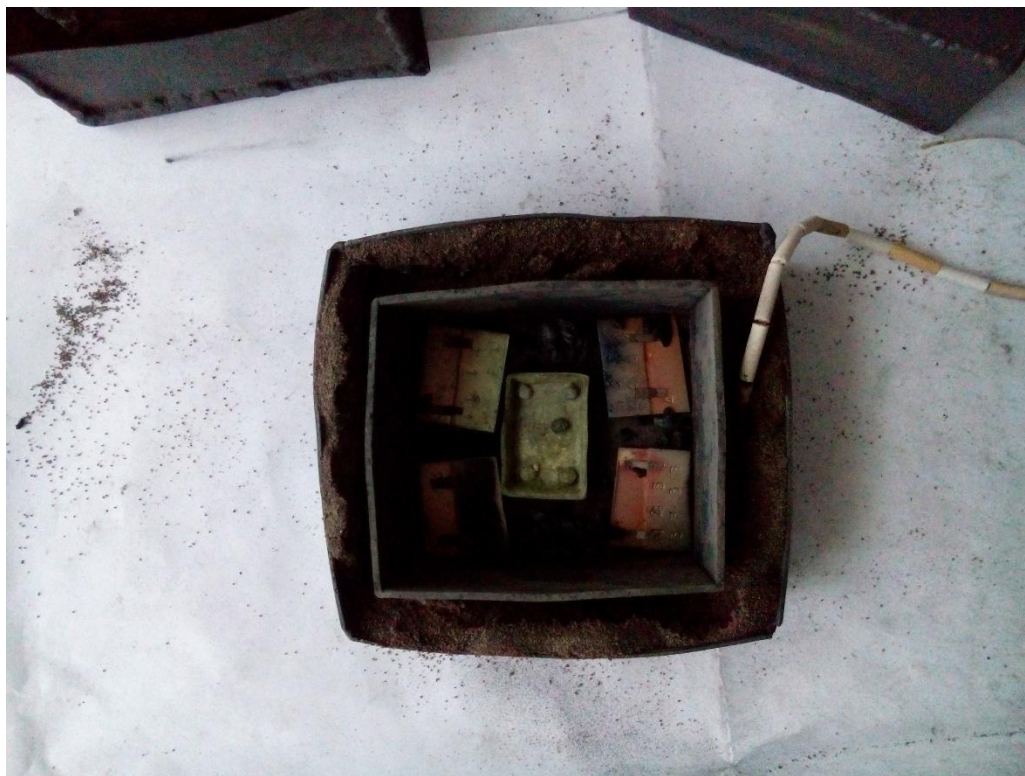
Рисунок 2.5 – Образцы после пайки, 1 опыт
