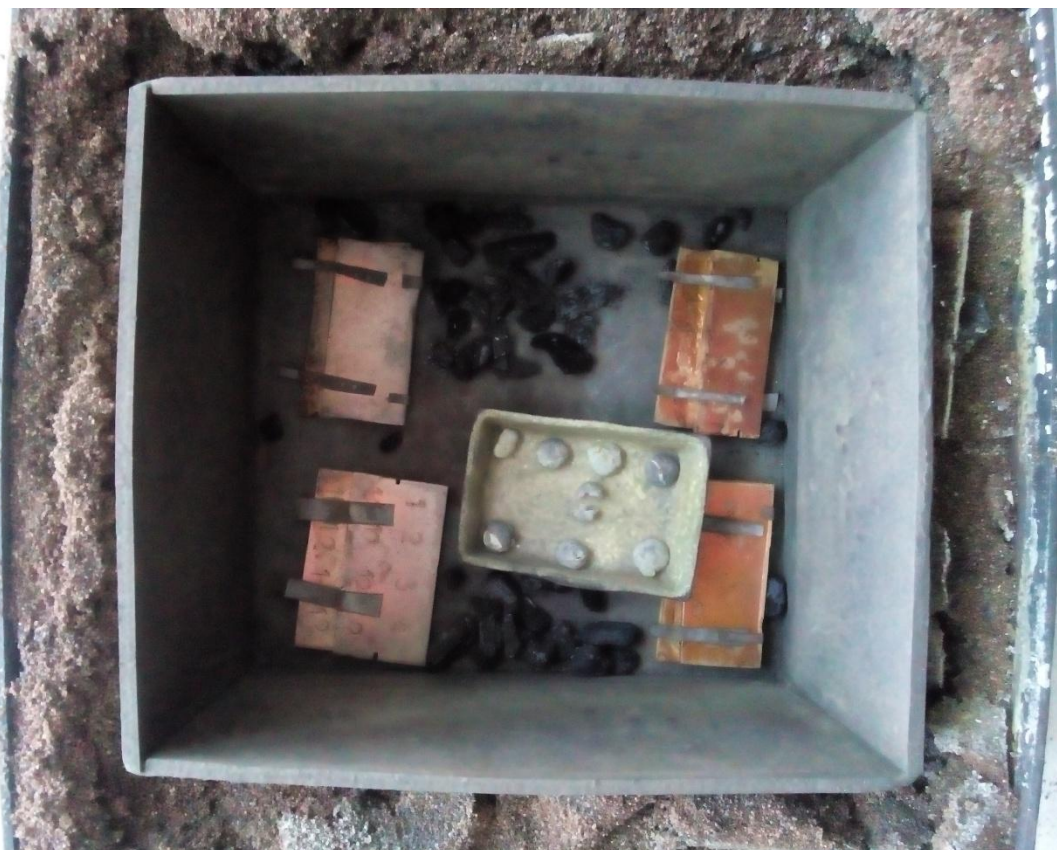
Рисунок 2.9 – Образцы после пайки, 3 опыт
