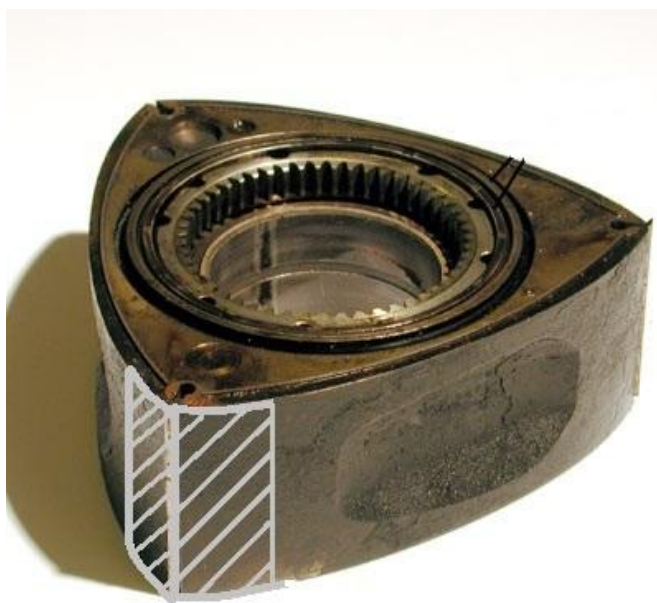
Рисунок 1.4 – Зона изнашивания ротора ДВС
