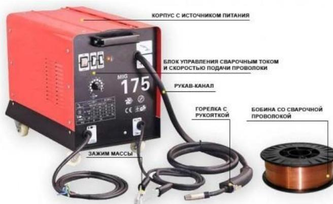
Рисунок 2.9 – Полуавтомат для сварки металлов
