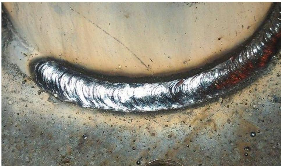
Рисунок 2.6 – Шов ручной дуговой сварки плавящимся электродом
