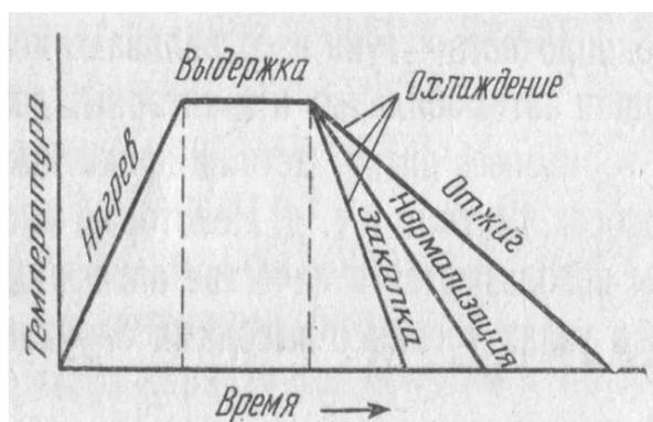
Рисунок 2.17 график зависимости термообработки от времени
