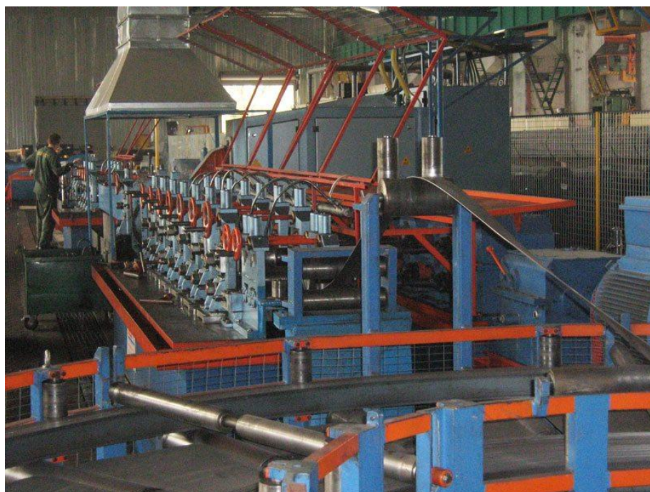
Рисунок 1.2 - Линия по производству сварных труб
