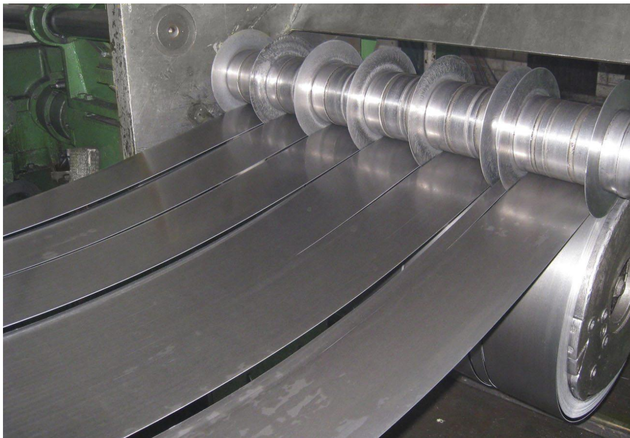
Рисунок 1.1 - Штрипс разматывается и нарезается на узкие полосы
